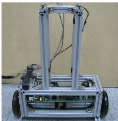
شکل ۲-۴: ربات تعادلی طراحی شده به وسیله لونگ
