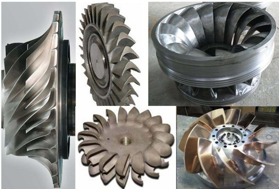
شکل ۳-۷ چند نمونه روتور توربین
