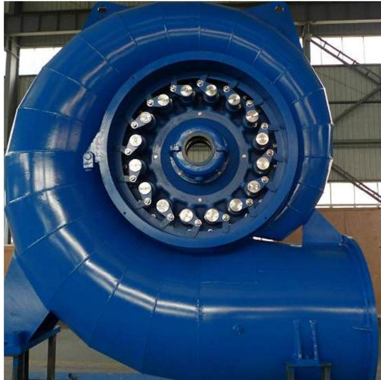
شکل ۳-۹ پوسته حلزونی یک توربین فرانسسیس
