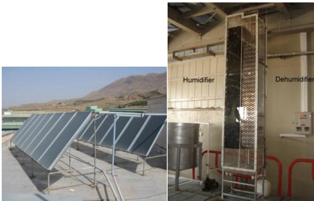
شکل (۲-۸): نمایی از سه بخش رطوبت زن، رطوبت زدا و کلکتور خورشیدی [۲۳]
