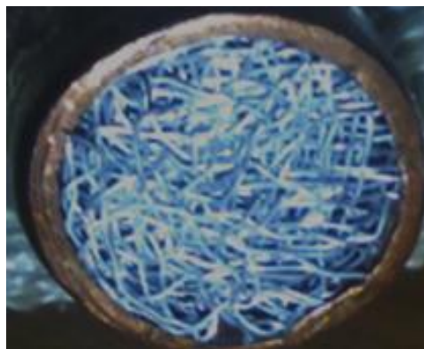
شکل ۲-۳ تخلخل بدست آمده با استفاده از جایگذاری توری آلومینیومی
