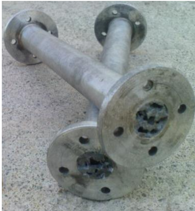
شکل ۱-۳ لوله تست با ماده متخلخل متصل ساخته شده با روش عامل فوم ساز
