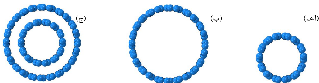
شکل (۸-۲) نحوه مدل سازی نانولوله دو جداره (الف) نانولوله داخلی (ب) نانولوله خارجی (ج) نانولوله دو جداره
