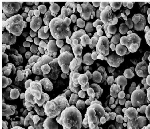
شکل (۱-۱) نمایی از ذرات فرومغناطیس در سیال مگنتوریولوژیک
