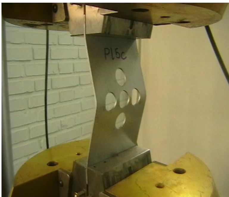
شکل ۶-۱۸ فرم کمانش تجربی و عددی نمونه Pl5c
