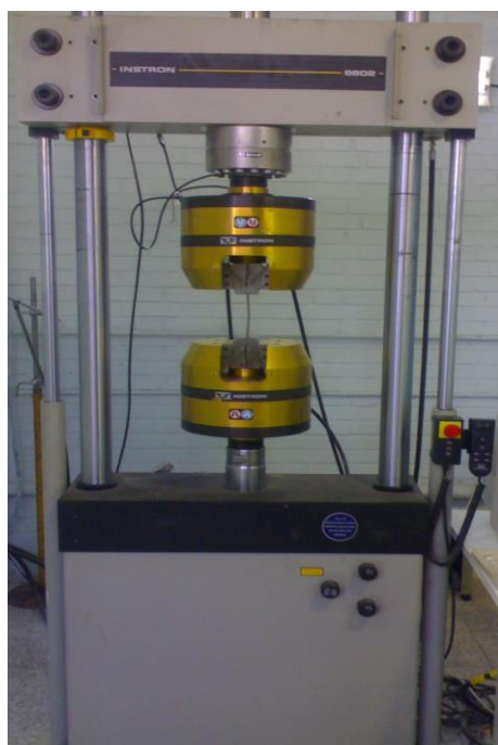
شکل ۵-۱ دستگاه سروهیدرولیک INSTRON 8802
