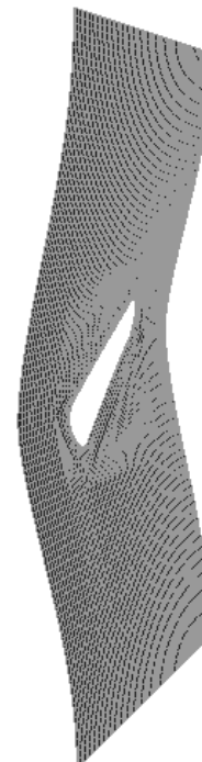
شکل ۶-۲۰ فرم کمانش تجربی و عددی نمونه pls-150-100,2-49,7-10-60-2,07
