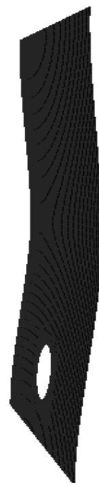
شکل ۶-۱۵ فرم کمانش تجربی و عددی نمونه pl-150-100,07-49,97-0-20,2-2,05
