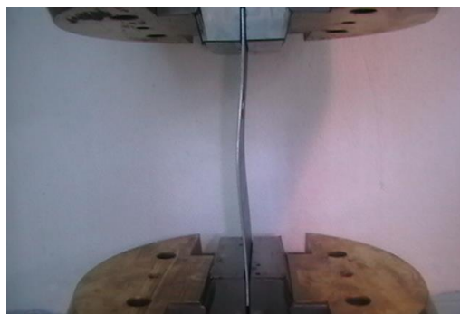
شکل ۵-۸ نحوه قرار گرفتن نمونه‌ها در فک‌های هیدرولیکی
