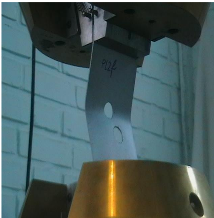
شکل ۶-۱۶ فرم کمانش تجربی و عددی نمونه pl2f
