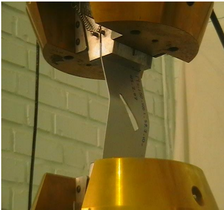
شکل ۶-۱۹ فرم کمانش تجربی و عددی نمونه pls-150-100,1-59,7-10-45-2,07
