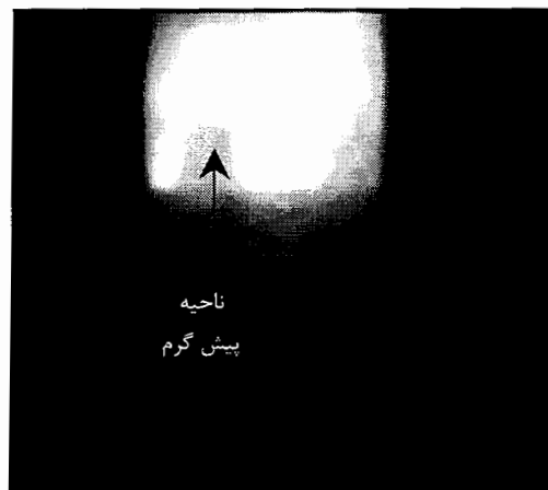
شکل ۳-۱۳- پیشروی ناحیه پیشگرم در داخل شعله غلظت ذرات 240 \text{ g/m}^3
