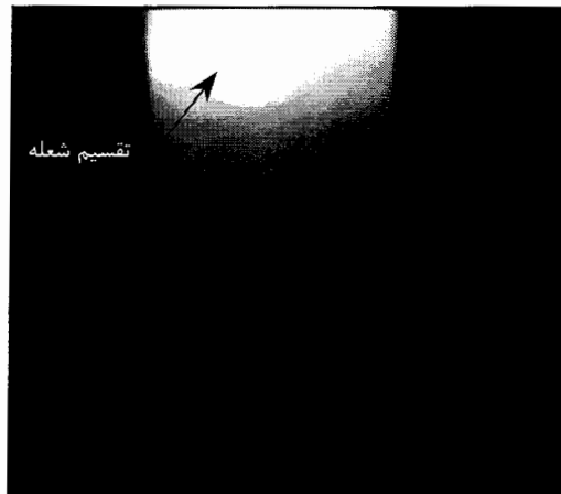
شکل ۳-۱۴- چند تکه شدن شعله آشفته غلظت ذرات 240 \text{ g/m}^3
