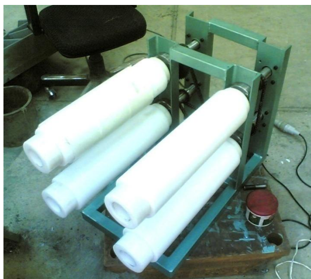
شکل (۵-۱۲) مکانیزم دورانی هرزگرد برای حفظ یکنواختی نمونه‌ها [۸۱].
