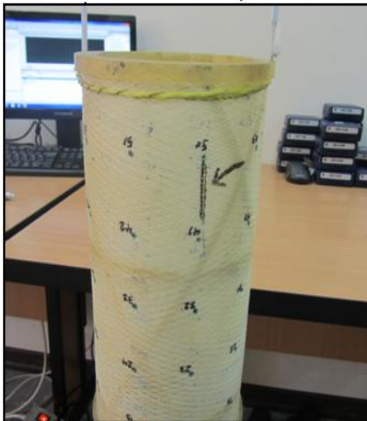
شکل (۵-۲۱) موقعیت عیب ایجاد شده در سازه مورد آزمایش.
