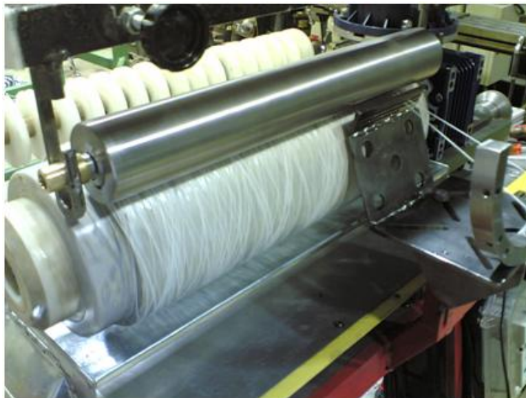
شکل (۵-۱۱) استوانه جبران کننده کمبود رزین [۸۱].
