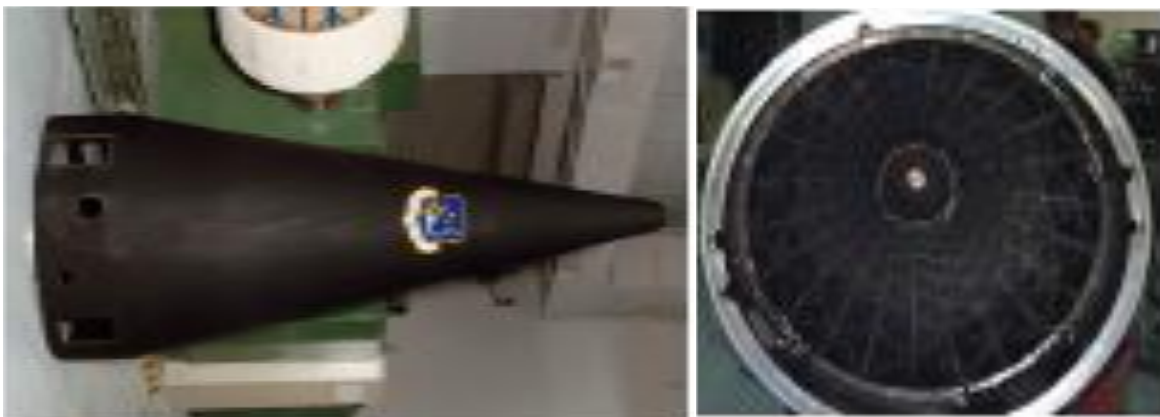
شکل (۲-۳) دماغه موشک سبک از جنس کامپوزیت تقویت شده [۷].
