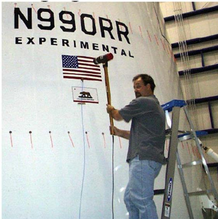
شکل (۲-۶) نگهداری بدنه یک هواپیما روی زمین جهت انجام آنالیز مودال.
