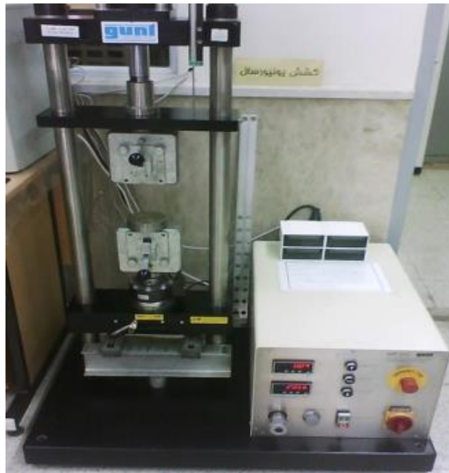
شکل ۲-۱۴- دستگاه تست فشار برای اندازه‌گیری استحکام
