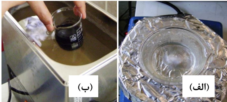
شکل ۲-۴- الف) محلول نیترات آلومینیم ب) پراکنده‌سازی نانولوله کربنی درون محلول نیترات آلومینیم توسط دستگاه فراصوت
