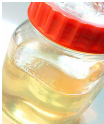
شکل ۲-۳- محلول یکنواختی از پلی وینیل الکل با ۸ درصد وزنی
