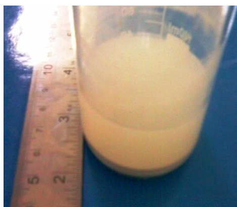
شکل ۲-۸- ته‌نشین شدن اجزای نمونه گرده پس از فراصوت
