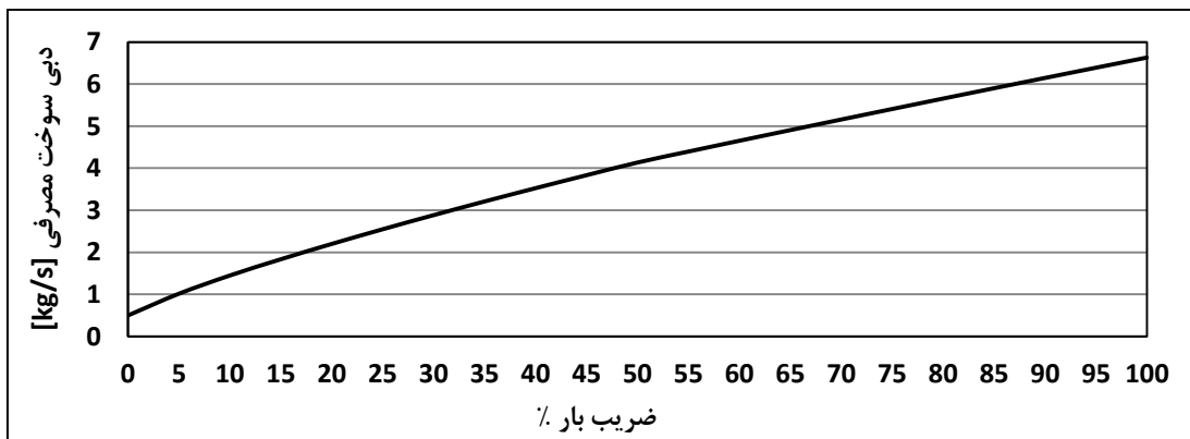
شکل ۴-۳۵: تغییرات دبی سوخت در مقابل تغییرات بار توربین در دمای ثابت
