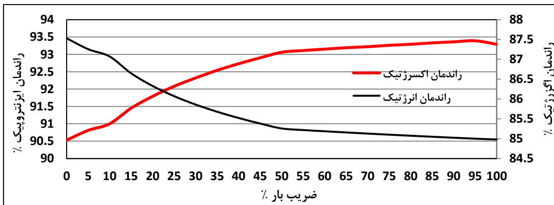
شکل ۴-۳۳: تغییرات راندمان ایزنتروپیک و اگزرتیک کمپرسور با تغییر بار در دمای ثابت
