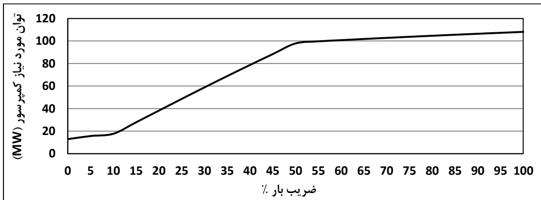
شکل ۴-۳۲: تغییرات توان مصرفی کمپرسور در برابر تغییرات بار در دمای ثابت
