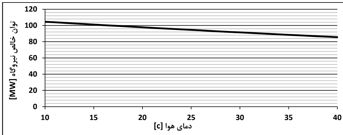
شکل ۴-۱۵: تغییرات توان خالص تولیدی در برابر تغییر دمای هوا در نیروگاه گازی فولاد مبارکه
