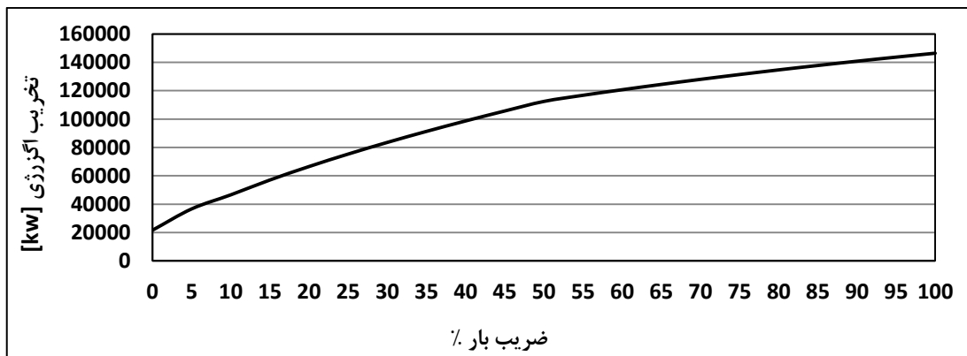
شکل ۴-۳۶: تغییرات در میزان تخریب اگزورژی در محفظه احتراق در بارهای متفاوت به ازای دمای ثابت
