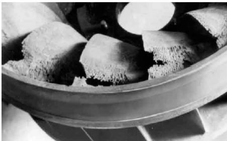
شکل ۱-۱۳ خوردگی در اثر فروپاشی حباب‌های شکل گرفته در پره‌های خروجی یک توربین فرانسس [۱]
