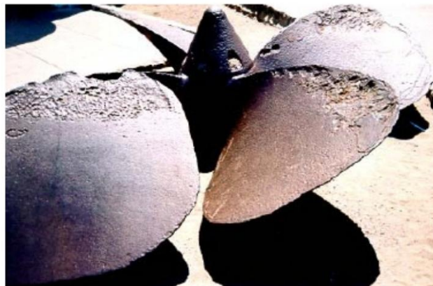
شکل ۱-۳ خوردگی پره‌های کشتی بواسطه کاویتاسیون
