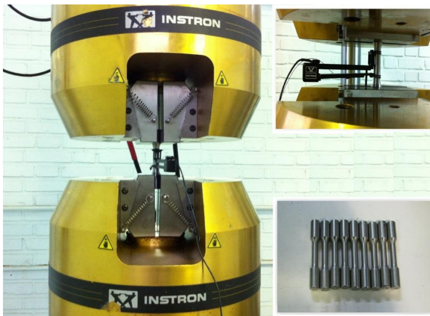
شکل ۲-۱: دستگاه سرو هیدرولیک اینسترون ۸۸۰۲ و نمونه های آزمایش
