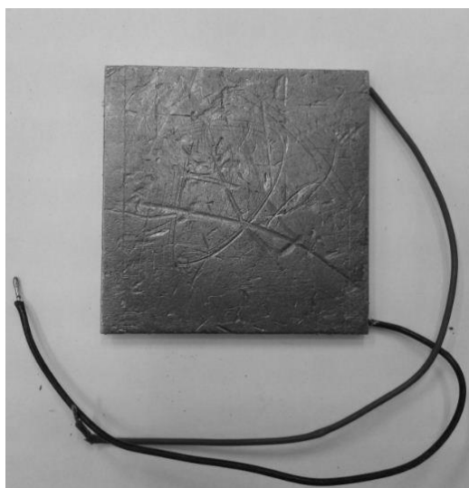
شکل ۴-۴: ترموالکتریک مورد آزمایش [88]
