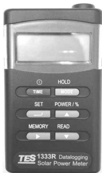
شکل ۴-۲۴: تابش‌سنج استفاده شده در اندازه‌گیری شدت تابش خورشید [91]
