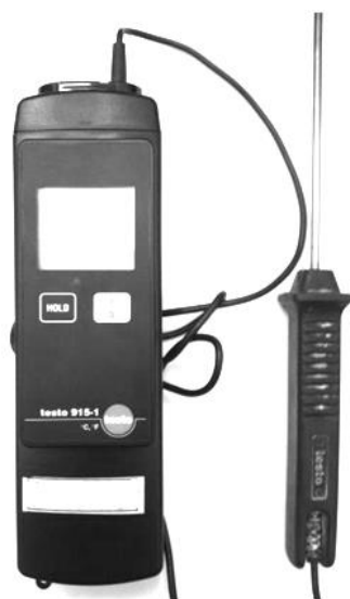
شکل ۴-۲۲: دماسنج ترموکوپلی استفاده شده در اندازه‌گیری دمای آب [90]
