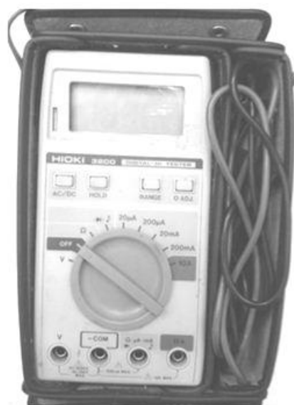
شکل ۴-۲۳: آوومتر استفاده شده در اندازه‌گیری ولتاژ [91]
