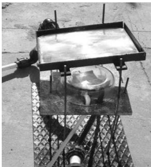
شکل ۴-۲۰: یک سیستم خورشیدی مورد آزمایش با قابلیت تولید برق و آب گرم
