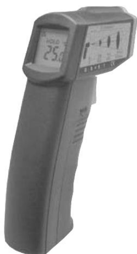
شکل ۴-۲۱: دماسنج لیزری استفاده شده برای اندازه‌گیری دمای سطح گرماگیر مبدل [89]
