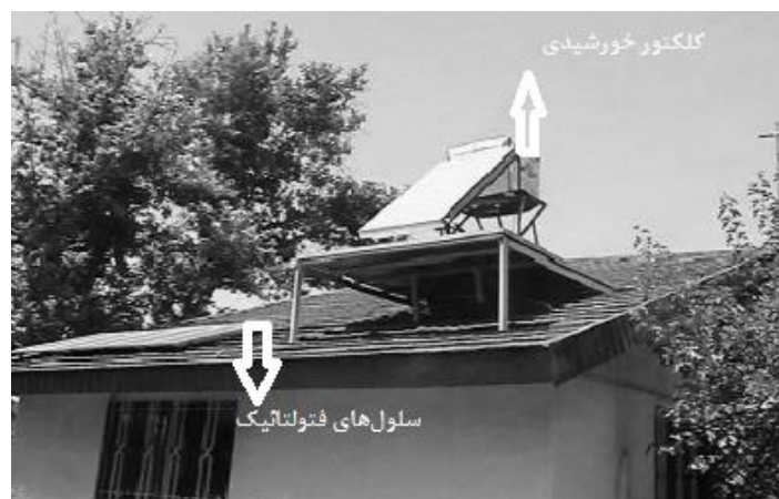
شکل ۴-۱: نمونه‌ای از طرح‌های اجرا شده برای تولید الکتریسیته و آب گرم با استفاده از نور خورشید [83]
