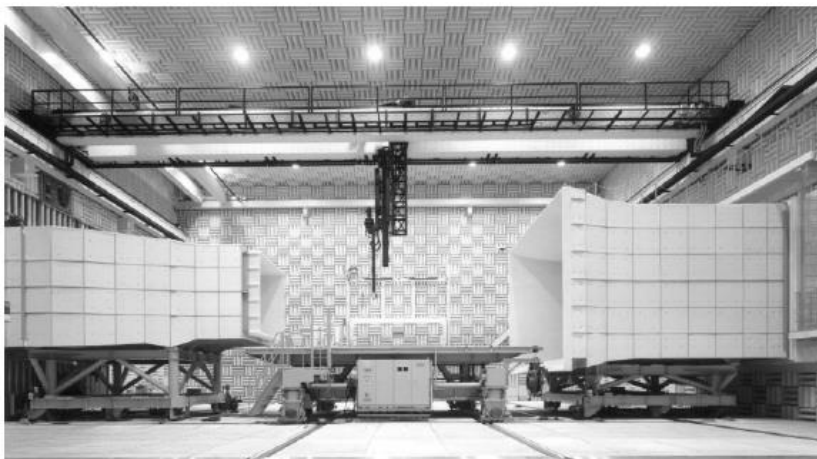
شکل (۲-۴) تونل باد مدار بسته با اتاق آزمون باز
