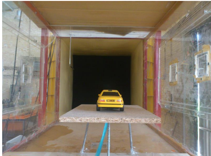
شکل (۲-۳) نمایی از مدل در اتاق آزمون تونل باد
