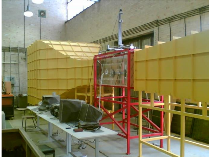
شکل (۲-۲۴) تونل باد مدار باز دانشگاه شاهرود
