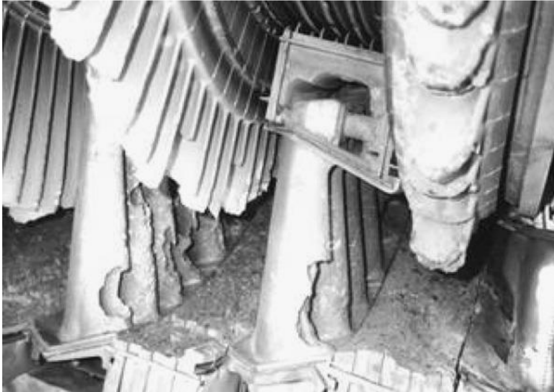
شکل (۱-۳) آسیب‌های شدید وارده بر محفظه و پره‌های استاتور [۹]
