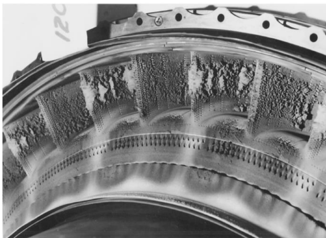
شکل (۹-۱) رسوب‌های آتشفشانی ۱ در پره‌های استاتور توربین [۱۴]
