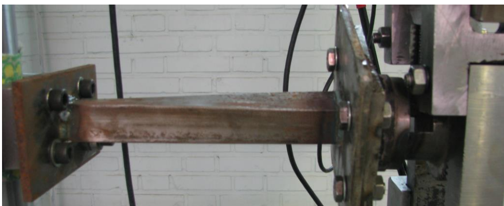
شکل ۲-۴۳: تغییر شکل در پوسته مکعبی در انتهای بارگذاری گشتاور-کنترل
