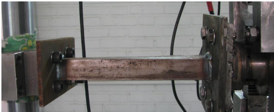
شکل ۲-۴۱: اتصال پوسته مکعبی به صفحات با جوشکاری سرد
