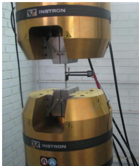
شکل ۲-۲: آزمایش کشش استاندارد با استفاده از دستگاه Instron 8802
