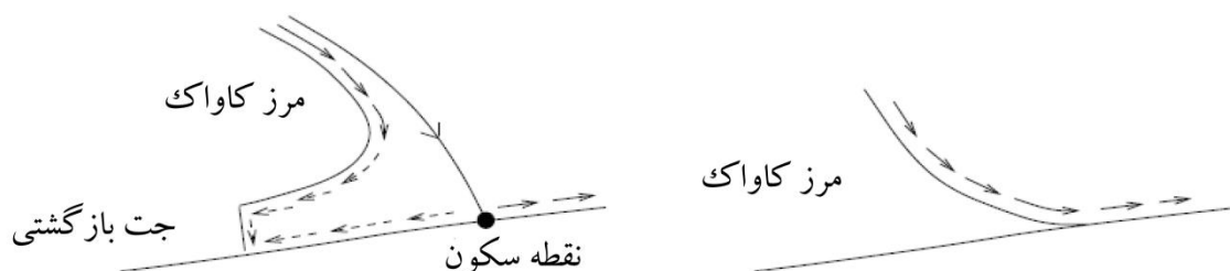
شکل ۷-۱ حالت‌های مختلف بسته شدن کاواک و تشکیل جت بازگشتی [۶]
