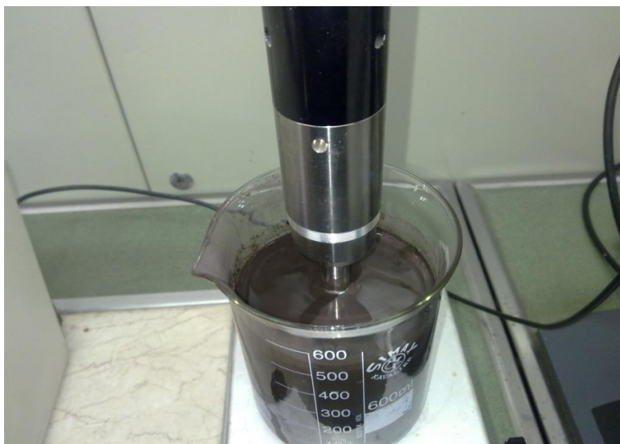
شکل (۳-۳) نانوسیال در حال تهیه به وسیله دستگاه اولتراسونیک
