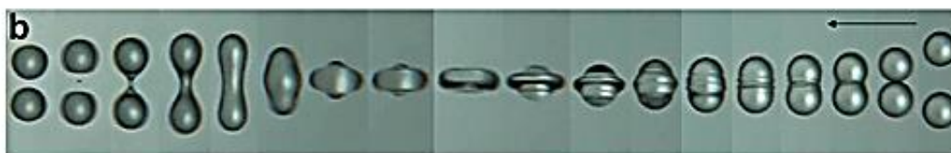
ب) جدایش انعکاسی (a) دیزل-اتانول، (b) دیزل-دیزل، در We \approx 35 [۱۲]
