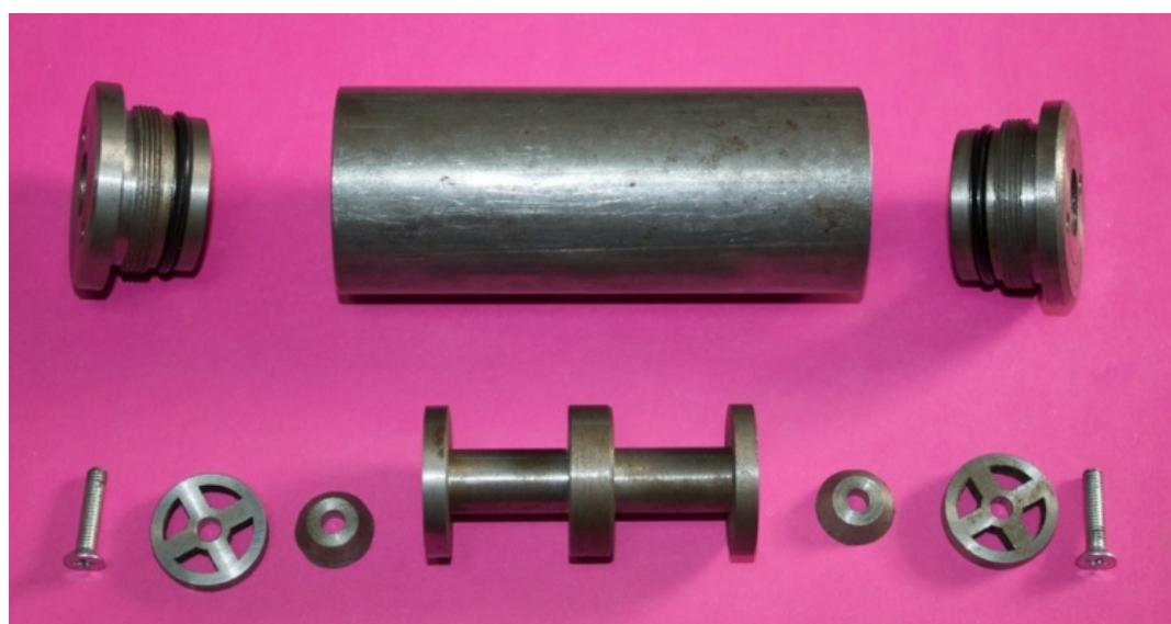
شکل ۴-۲۳- نمونه اولیه شیر مغناطیسی ساخته شده.
