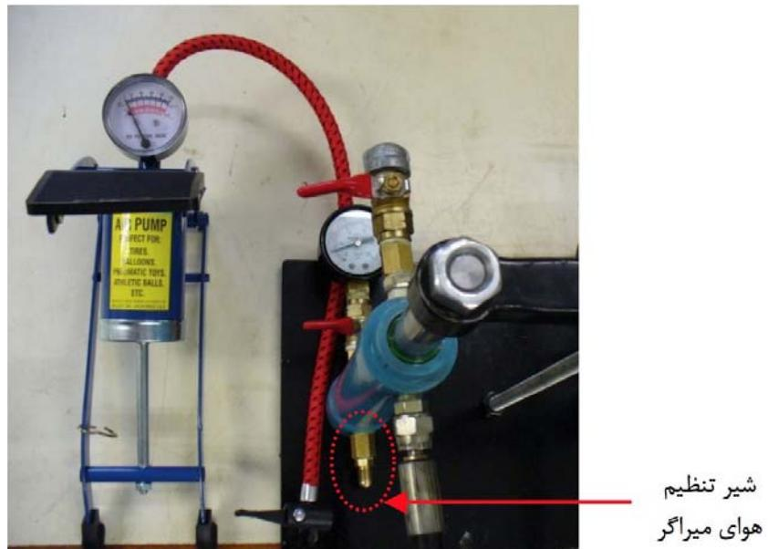
شکل ۴ - ۱۰ - تغییر فشار گاز مخزن با استفاده از پمپ هوای دستی.
