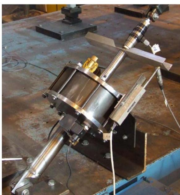
شکل ۲-۱۹- نمای نزدیک میراگر دو-محفظه‌ای متصل به سازه مورد آزمایش به همراه سنسور تغییرمکان (به صورت موازی با میراگر) و سنسور نیرو (در امتداد شفت) [۶۸].
