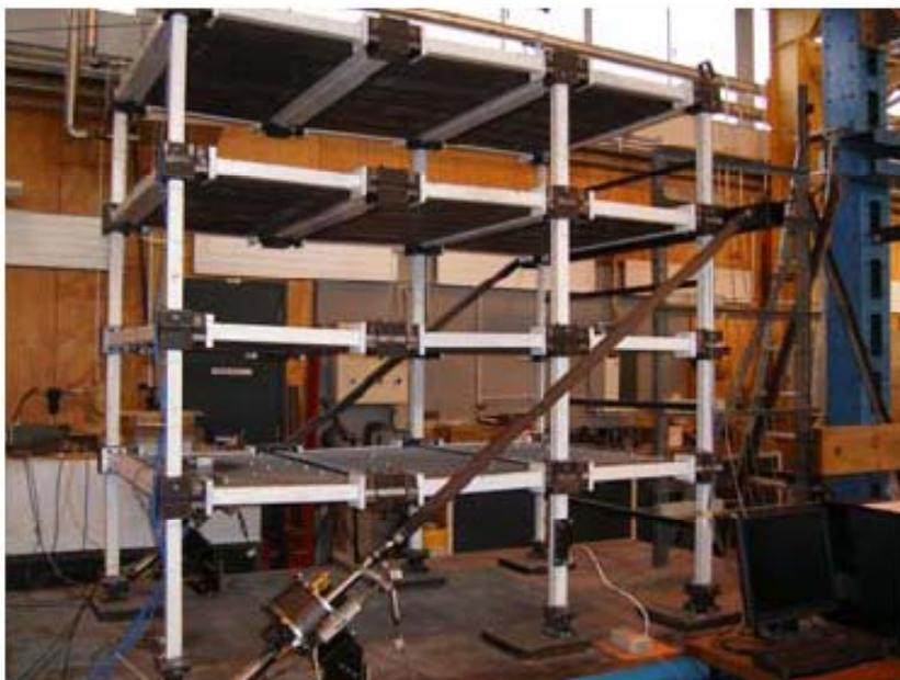
شکل ۲-۱۸- سازه چهار طبقه آزمایش شده مجهز به میراگرهای باز تنظیم شونده دو-محفظه‌ای [۶۷].
