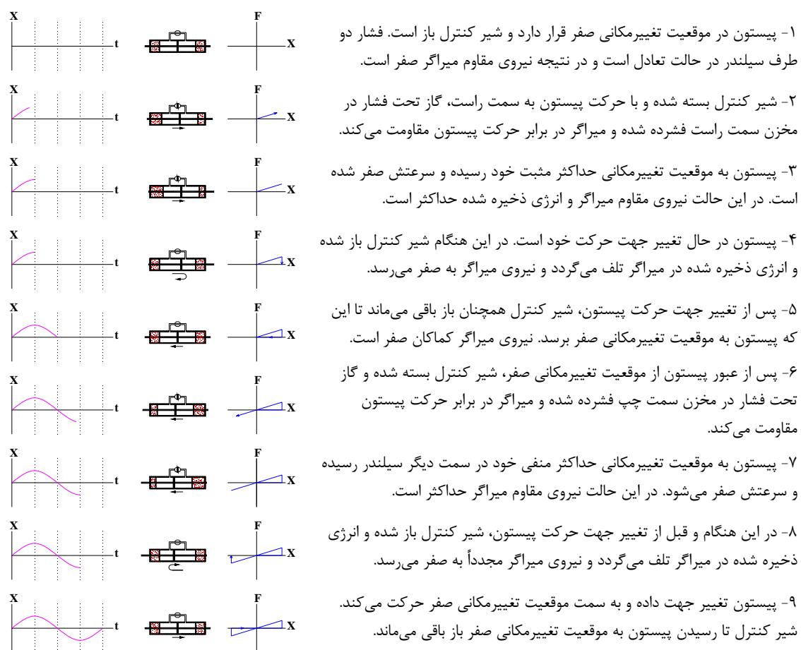
شکل ۳-۹- روش کنترل قطع و وصل نوع ۱ برای یک تحریک سینوسی اعمال شده به میراگر ابداعی
