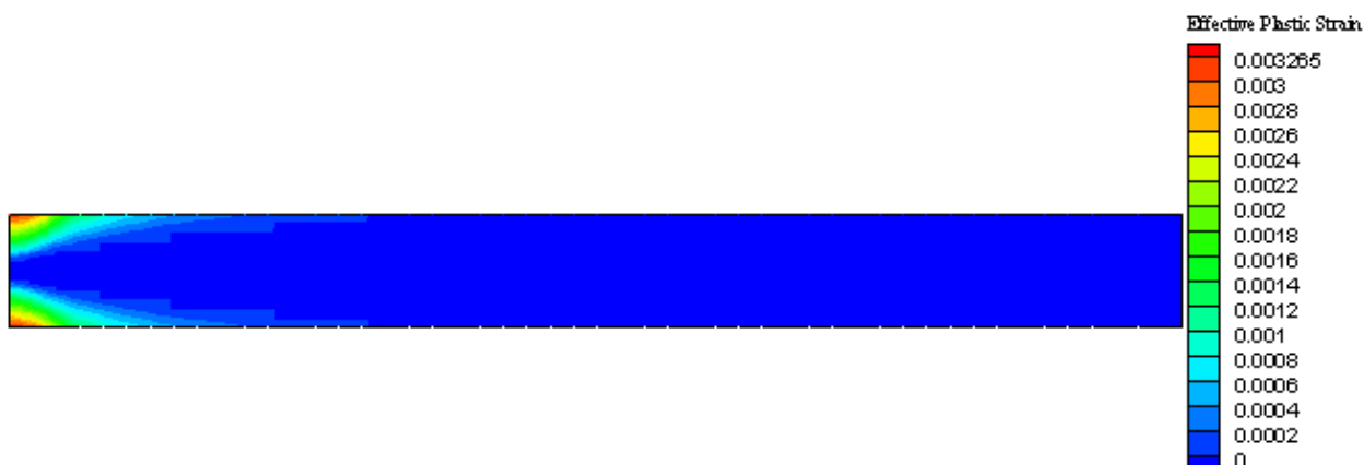
شکل ۵-۲۴). کرنش موثر پلاستیک تیر یکسرگردار (تحلیل توسط روش ایزوژئومتری)
