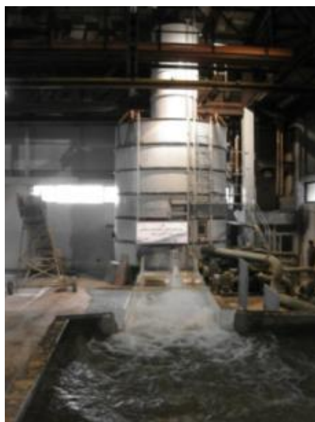
شکل ۳-۱: نمایی از مخزن تامین هد مدل
