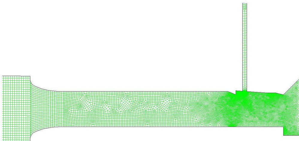
شکل ۴-۷: نمایی از مشبندی مدل ۲
