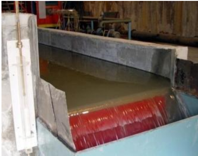
شکل ۳-۳۰: نمایی سرریز مستطیلی مورد استفاده جهت اندازه‌گیری دبی جریان
