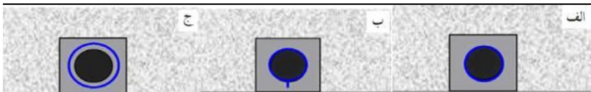
شکل 2-2: شکل‌های گسیختگی در چسب. (الف) و (ب): گسیختگی در سطح مشترک چسب - میله، (ج): گسیختگی برشی در چسب
