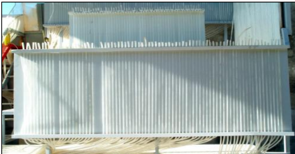
شکل (۳-۱۲) صفحه مانومتر جهت اندازه‌گیری فشارهای استاتیکی
