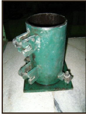
شکل ۵-۵: قالب و نمونه استوانه ای 100x200 برای آزمایش فشار
