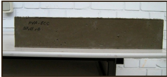
شکل ۵-۶: قالب و نمونه تیر 100 \times 100 \times 500 برای آزمایش خمش
