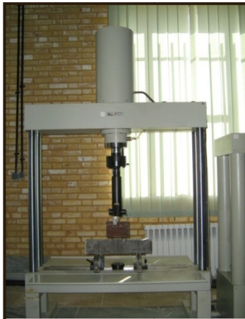
شکل ۵-۷: دستگاه یونیورسال جهت انجام آزمایش خمش
