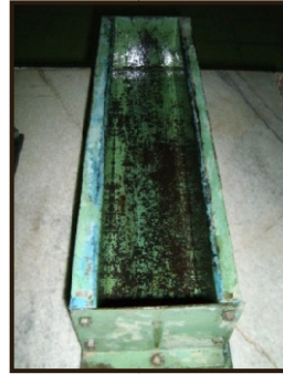
شکل ۵-۶: قالب و نمونه تیر 100 \times 100 \times 500 برای آزمایش خمش
