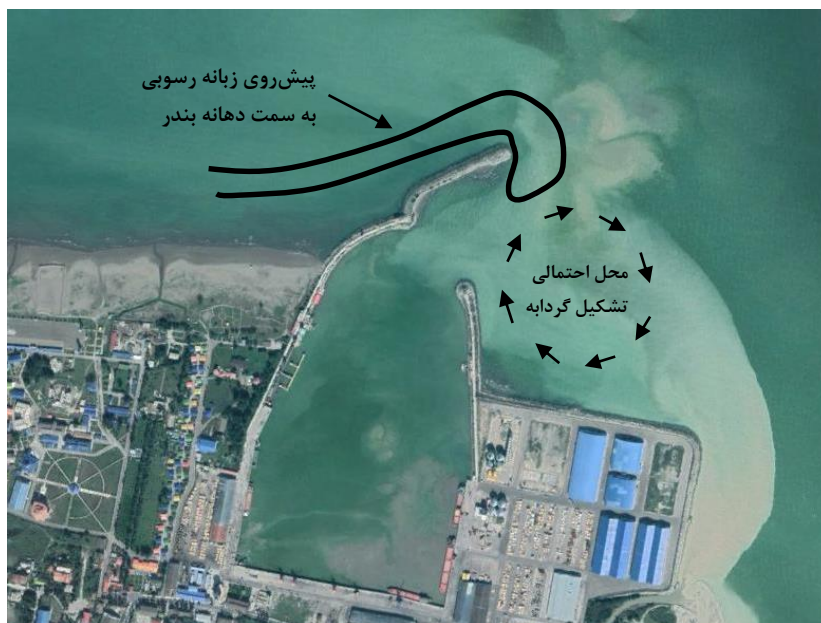
شکل ۳-۱۳. تشکیل زبانه رسوبی پس از ساخت اطاله موجشکن
