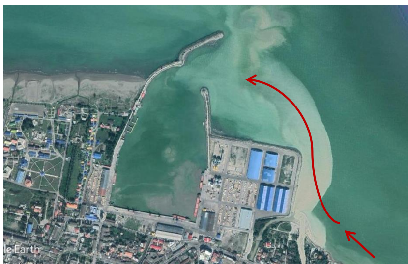
شکل ۴-۲۲. انتقال رسوبات رودخانه ماشلک همراه جریان شرق به غرب
