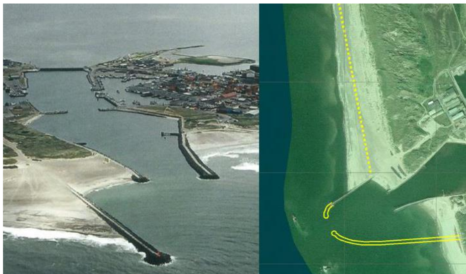
شکل ۲-۱۲. طرح پیشنهادی جدید برای بندر Hvide sande (Mangor, 2010)
