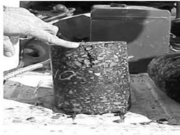
شکل ۲-۲. ترک خوردگی از بالا به پایین در یک نمونه‌ی آسفالت [۵]
