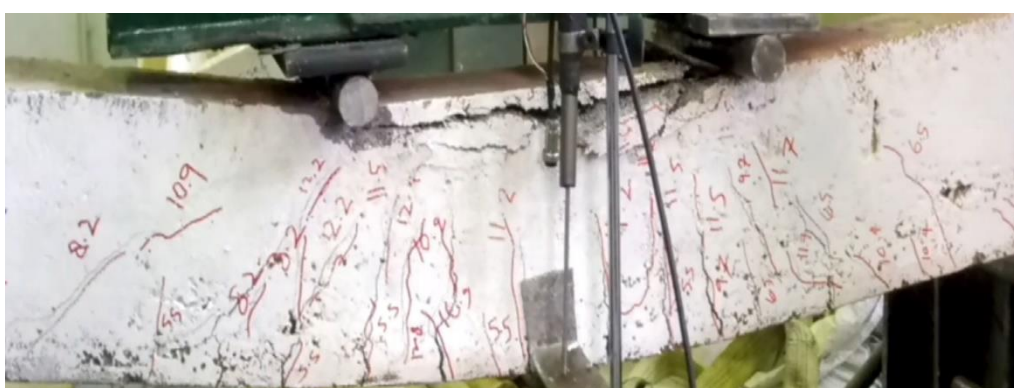
شکل ۳-۱۹: ترک‌های ایجاد شده در نمونه بدون الیاف و بدون خوردگی (NC)
