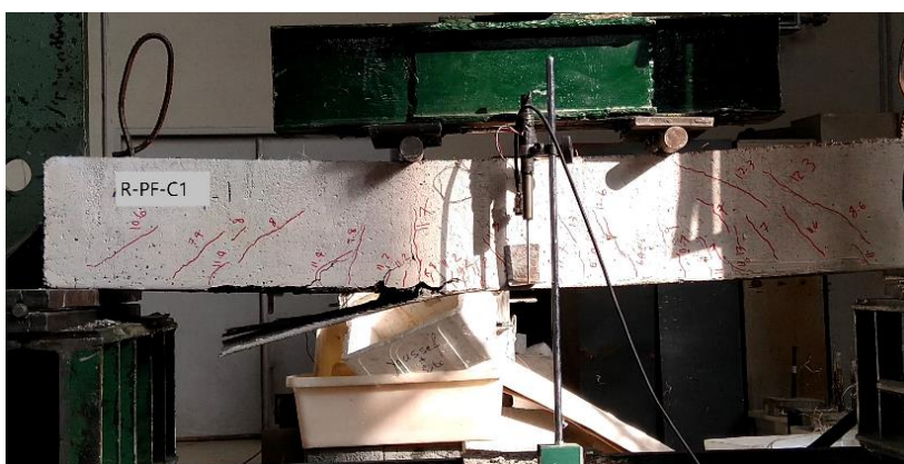
شکل ۳-۵۳: ترک‌های ایجاد شده در نمونه با الیاف فلزی قلابدار و با خوردگی سطح یک (R-PF-C1)
