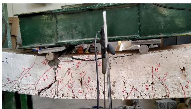
شکل ۳-۳۹: ترک های ایجاد شده در نمونه بدون الیاف و با خوردگی سطح یک (NC-C1)
