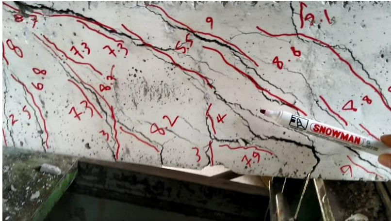
شکل ۳-۳۴: ترک‌های ایجاد شده در نمونه بدون الیاف و با خوردگی سطح دو (NC-C2)
