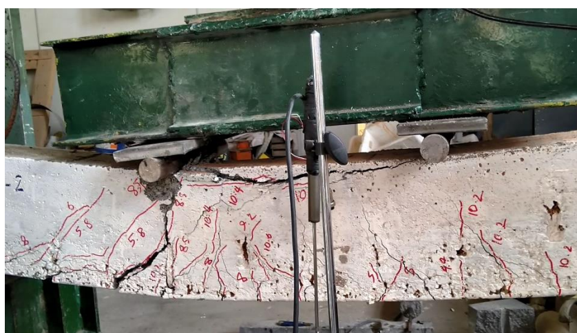
شکل ۳-۲۰: ترک‌های ایجاد شده در نمونه بدون الیاف و با خوردگی سطح یک (NC-C1)
