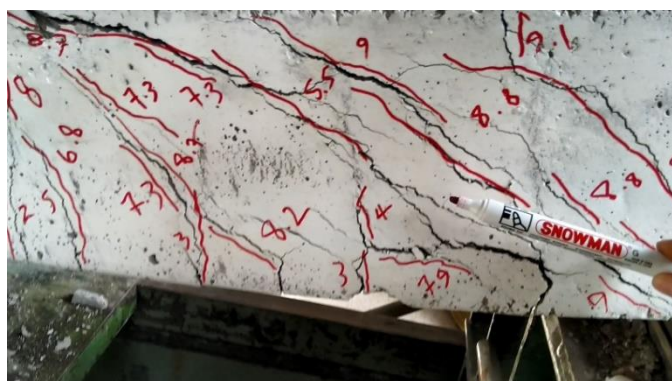
شکل ۳-۴۰: ترک های ایجاد شده در نمونه بدون الیاف و با خوردگی سطح دو (NC-C2)
