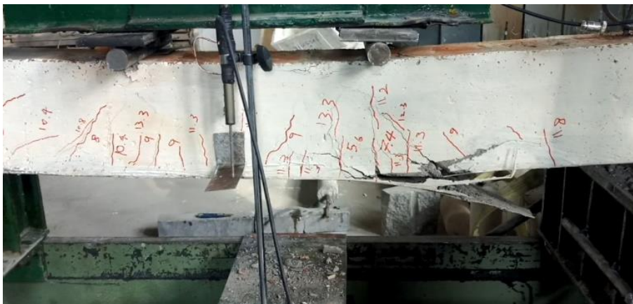
شکل ۳-۴۸: ترک‌های ایجاد شده در نمونه با الیاف فلزی قلابدار و با خوردگی سطح یک (R-SF-C2)
