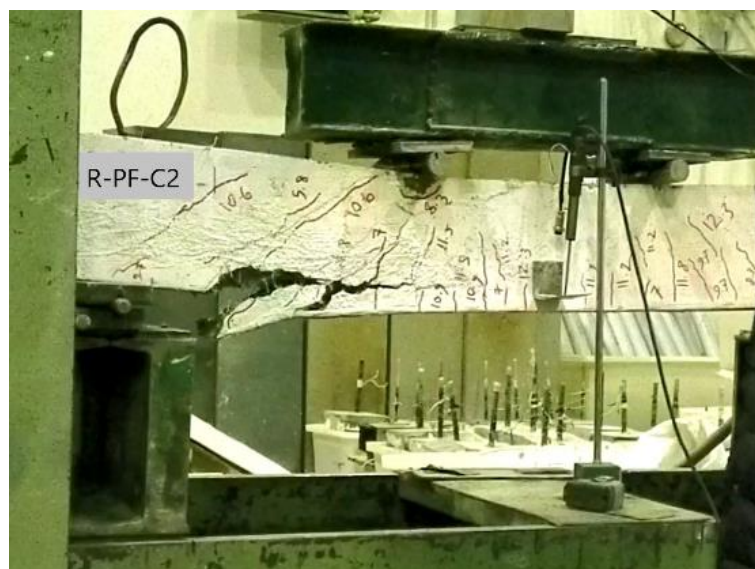
شکل ۳-۵۴: ترک‌های ایجاد شده در نمونه با الیاف فلزی قلابدار و با خوردگی سطح یک (R-PF-C2)
