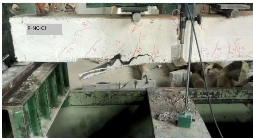
شکل ۳-۴۱: ترک‌های ایجاد شده در نمونه بدون الیاف و با خوردگی سطح یک مقاوم‌سازی شده با (R-NC-C1) GFRP
