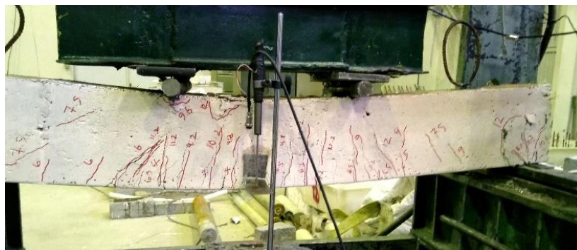
شکل ۳-۵۲: ترک‌های ایجاد شده در نمونه با الیاف فلزی قلابدار و با خوردگی سطح دو (PF-C2)
