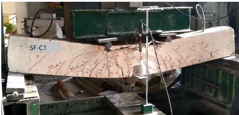
شکل ۳-۴۵: ترک‌های ایجاد شده در نمونه با الیاف فلزی قلابدار و با خوردگی سطح یک (SF-C1)
