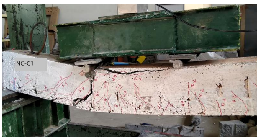
شکل ۳-۲۹: ترک‌های ایجاد شده در نمونه بدون الیاف و با خوردگی سطح یک (NC-C1)
