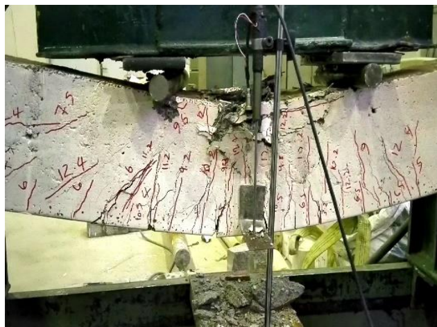
شکل ۳-۳۱: ترک‌های ایجاد شده در نمونه با الیاف فلزی قلابدار و با خوردگی سطح یک (PF-C1)
