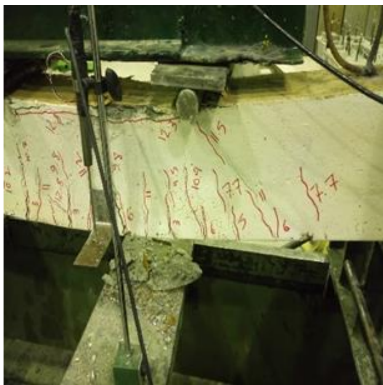
شکل ۳-۴۶: ترک‌های ایجاد شده در نمونه با الیاف فلزی قلابدار و با خوردگی سطح دو (SF-C2)
