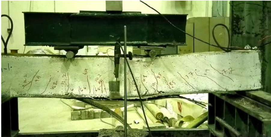
شکل ۳-۴۷: ترک‌های ایجاد شده در نمونه با الیاف فلزی قلابدار و با خوردگی سطح یک (R-SF-C1)
