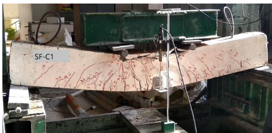
شکل ۳-۳۰: ترک‌های ایجاد شده در نمونه با الیاف فلزی قلابدار و با خوردگی سطح یک (SF-C1)
