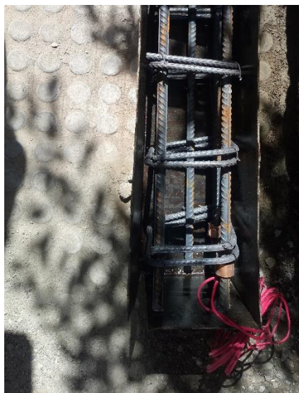
شکل ۳-۸: کابل مسی مورد استفاده برای میلگردهای طولی و عرضی به منظور برقراری جریان در مدار الکتریکی
