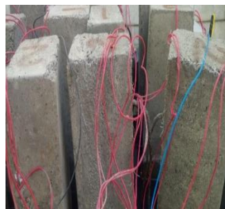
ب) مدار الکتریکی برای ایجاد خوردگی تسریع شده
