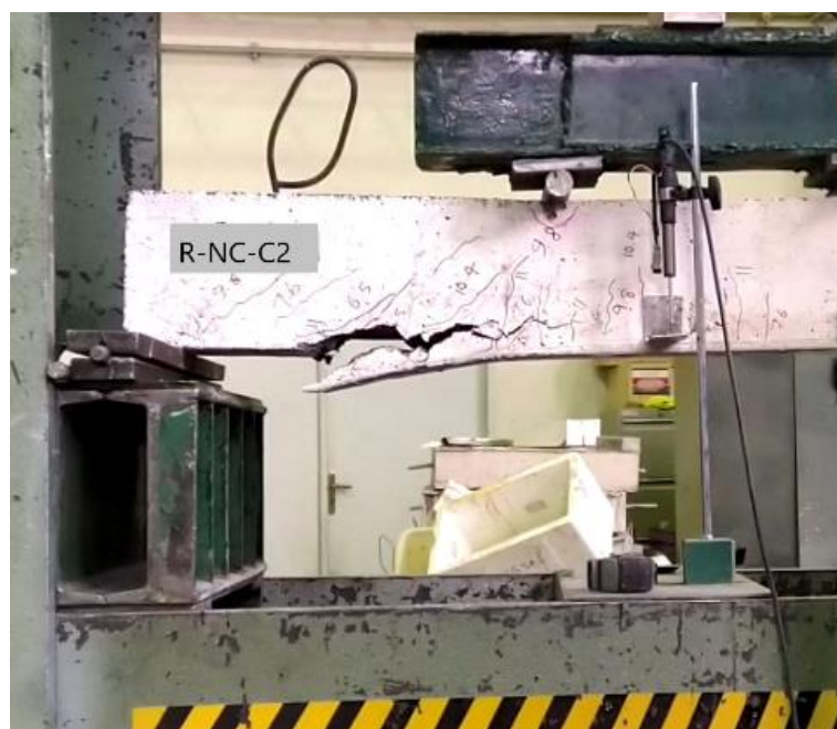
شکل ۳-۴۲: ترک‌های ایجاد شده در نمونه بدون الیاف و با خوردگی سطح دو مقاوم‌سازی شده با (R-NC-C2) GFRP
