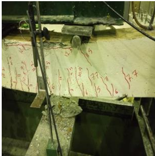
شکل ۳-۳۵: ترک‌های ایجاد شده در نمونه با الیاف فلزی قلابدار و با خوردگی سطح دو (SF-C2)
