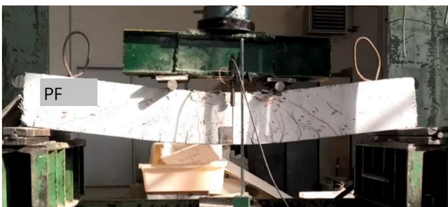
شکل ۳-۲۶: ترک‌های ایجاد شده در نمونه با الیاف فلزی قلابدار و بدون خوردگی (PF)
