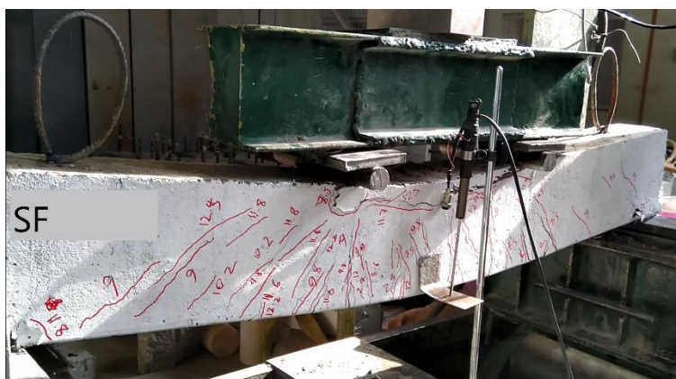
شکل ۳-۲۵: ترک‌های ایجاد شده در نمونه با الیاف فلزی قلابدار و بدون خوردگی (SF)
