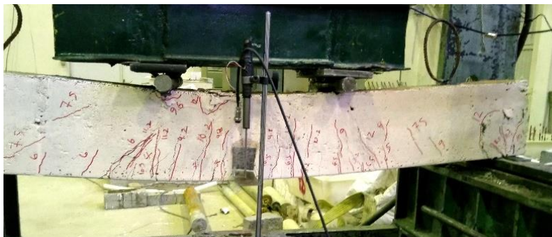
شکل ۳-۳۶: ترک‌های ایجاد شده در نمونه با الیاف فلزی قلابدار و با خوردگی سطح دو (PF-C2)
