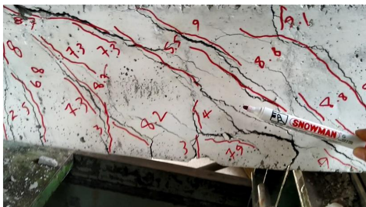
شکل ۳-۲۱: ترک‌های ایجاد شده در نمونه بدون الیاف و با خوردگی سطح دو (NC-C2)
