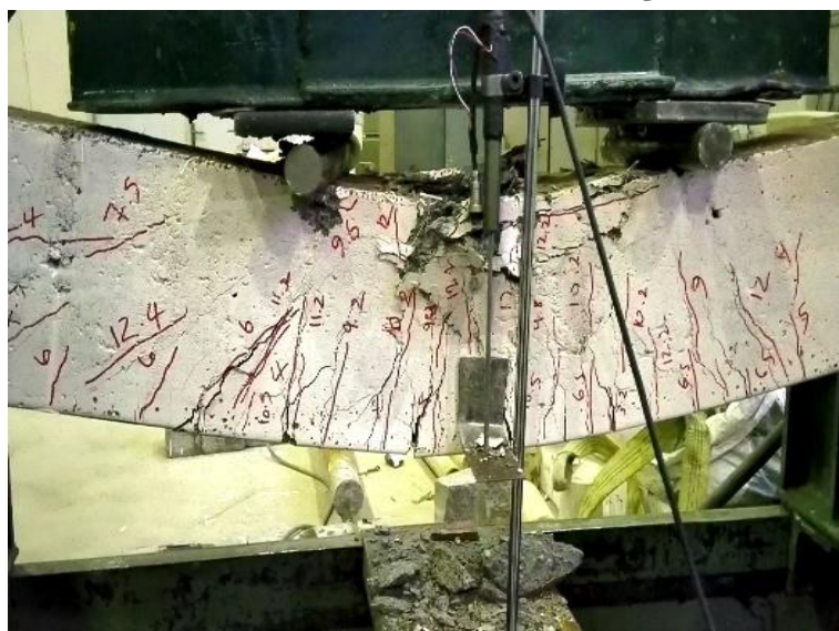
شکل ۳-۵۱: ترک های ایجاد شده در نمونه با الیاف فلزی قلابدار و با خوردگی سطح یک (PF-C1)
