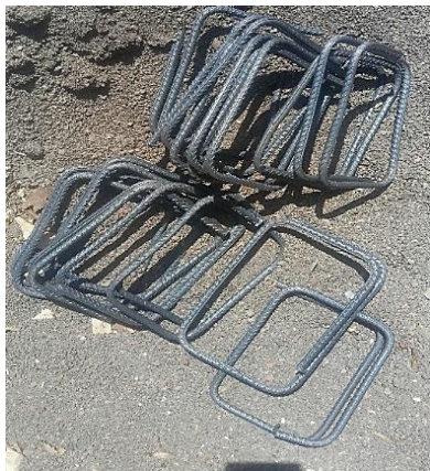
ب) میلگردهای عرضی ساخته شده در آزمایشگاه
