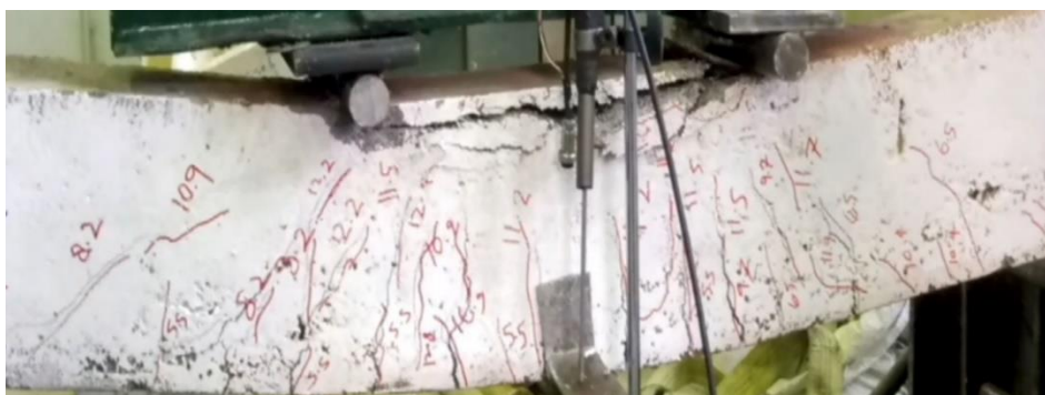
شکل ۳-۲۴: ترک‌های ایجاد شده در نمونه بدون الیاف و بدون خوردگی (NC)
