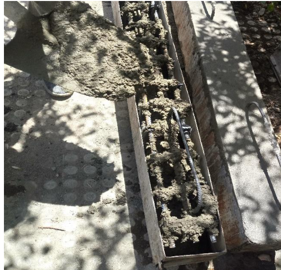
شکل ۳-۹- بتن‌ریزی نمونه‌ها در آزمایشگاه
