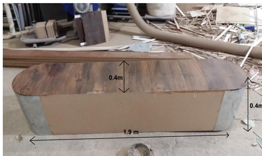
شکل ۴-۵- ابعاد مقیاسی جهت تبدیل ابعاد آزمایشگاهی به ابعاد واقعی
