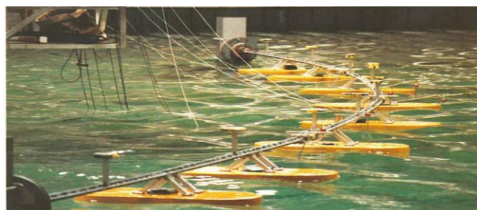
شکل ۲-۲۳- پل شناور بیورنافوردن E39 توسط شوشیانگ و همکاران (۲۰۱۹)
