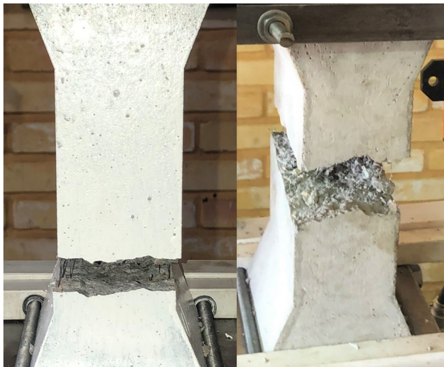
شکل (۵-۲۱) الگوی ترک خوردگی مصالح پایه سیمانی مسلح به ۰/۱۵ درصد الیاف
