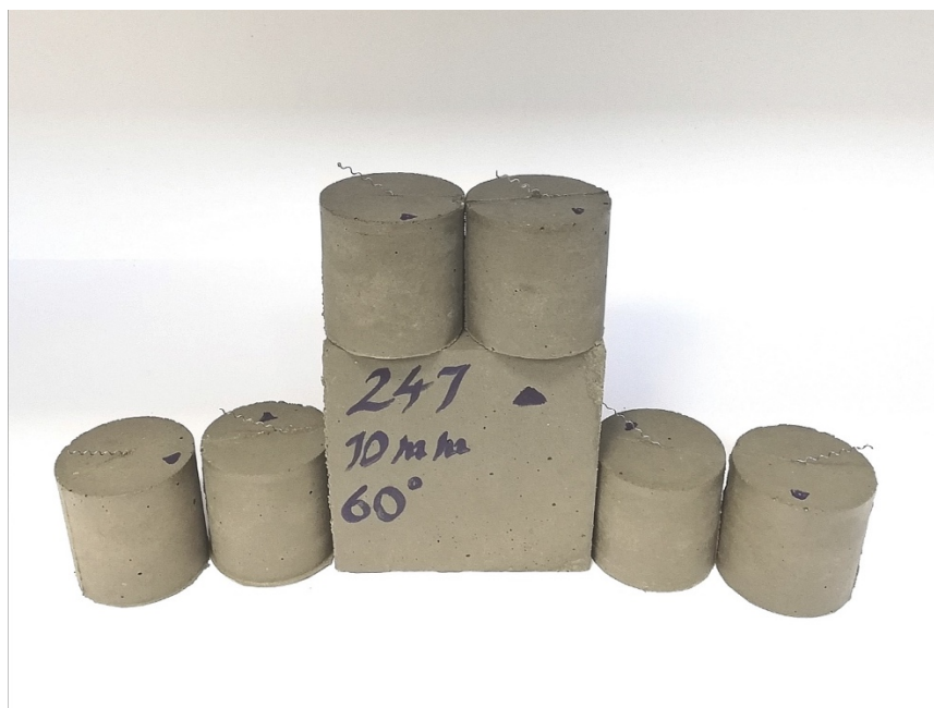
شکل ۱۱-۴ ( نمونه‌های آزمون بیرون کشیدگی الیاف
