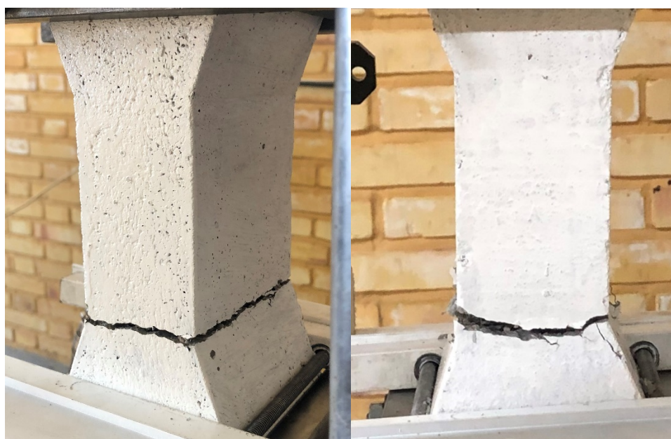
شکل (۵-۲۲) الگوی ترک خوردگی مصالح پایه سیمانی مسلح به ۰/۲۵ درصد الیاف
