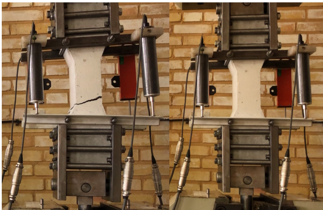
شکل (۵-۱۳) نحوه ترک‌خوردگی ماتریس پایه سیمانی مسلح به ۰/۱۵ درصد الیاف
