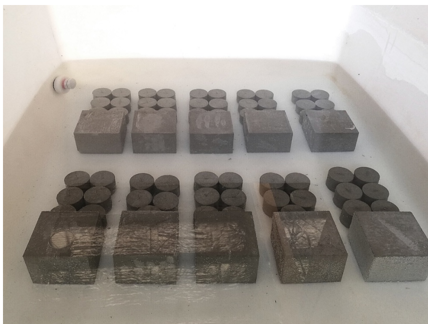
شکل (۴-۱۰) عمل‌آوری نمونه‌های پول اوت
