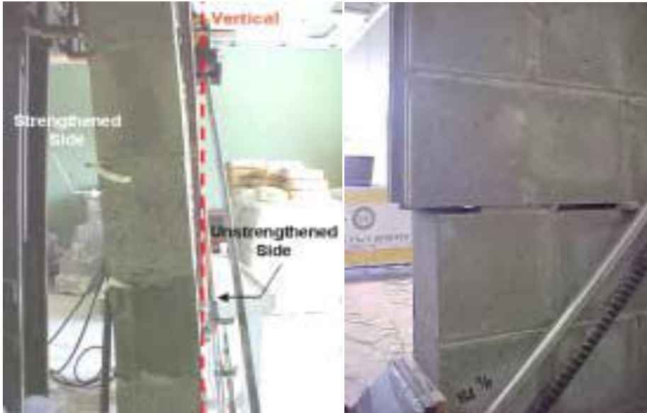
شکل ۴-۸- نحوه شکست نمونه‌ها [۶]
