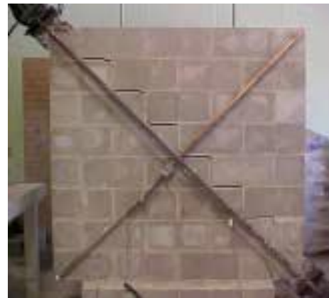
شکل ۴-۹- نحوه شکست نمونه‌ها و نتایج [۶]
