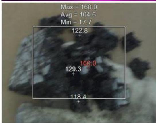
شکل ۲-۳۱ گسیختگی مخلوط های آسفالتی به دلیل گرمایش بیش از حد پس از ۱۲۰ ثانیه
