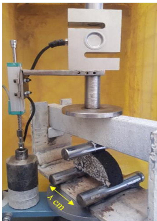
شکل ۳-۱۱ آزمایش خمش سه نقطه ای با دستگاه تک محوری و قالب ساخته شده
