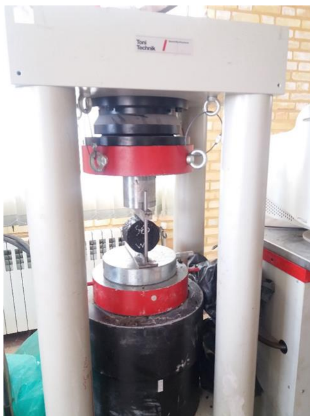
شکل ۳-۷ نمایی از آزمایش مقاومت کششی غیر مستقیم نمونه آسفالتی با دستگاه جک فشاری
