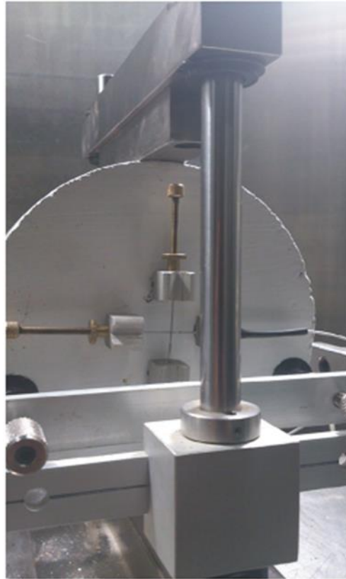
شکل ۲-۹ تصویر آزمایش کشش غیر مستقیم انجام گرفته بر روی نمونه ها [۲۶]
