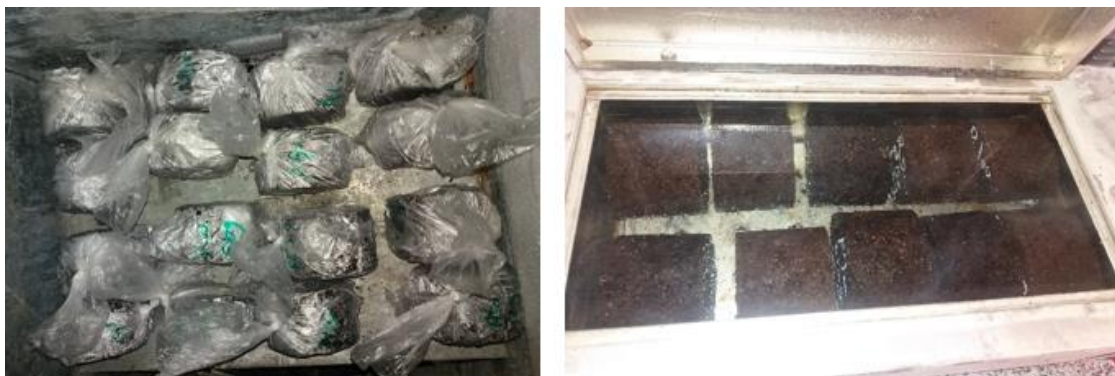
شکل ۳-۶ تصویری از سیکل ذوب و یخ نمونه های اشباع
