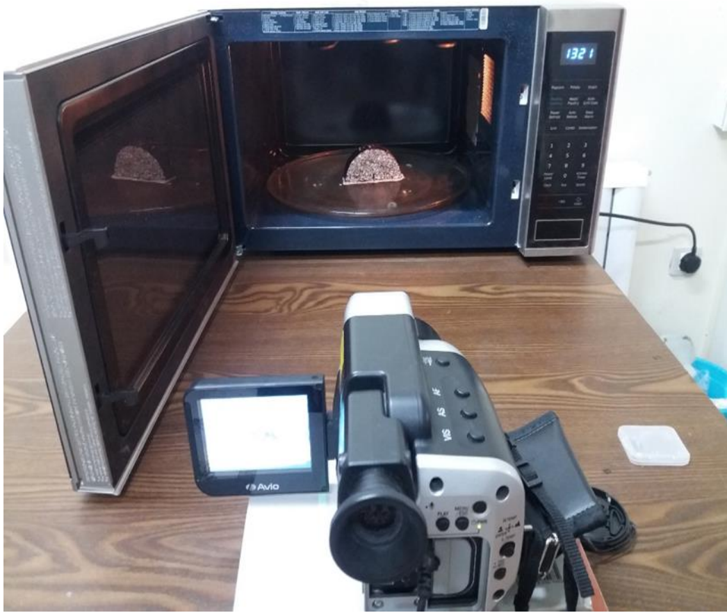
شکل ۳-۱۲ تصویر فرآیند گرمایش ماکروویو و ثبت دمای نمونه با دوربین حرارتی
