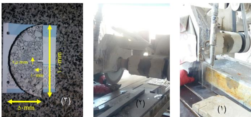
شکل ۳-۱۰ (۱) برش نمونه استوانه ای (۲) ایجاد شکاف در وسط نمونه (۳) نمونه نیمه استوانه ای نهایی
