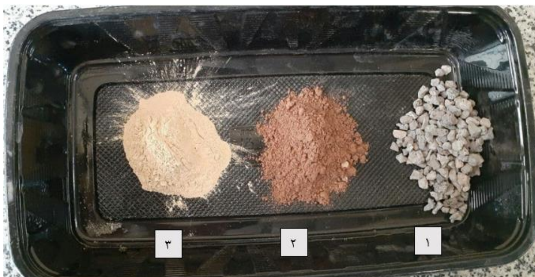
شکل ۱-۳-۱ نمایی کلی از ۳ نوع مصالح به ترتیب (۱) سرباره، (۲) گل قرمز و (۳) گل کربناته
