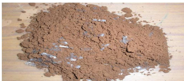
شکل (۲۱-۲) خاک مخلوط شده با خرده‌های ضایعاتی پلاستیک [32]
