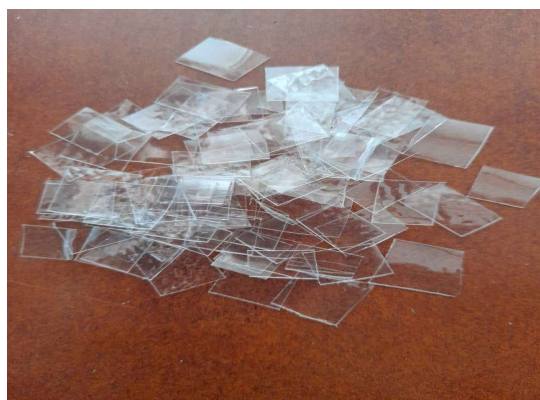
شکل (۲-۳) قطعات خرد شده پت استفاده شده برای تسلیح خاک
