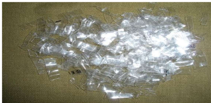
شکل (۲۰-۲) نمونه‌ای از خرده‌های ضایعاتی پت استفاده شده در آزمایش [32]
