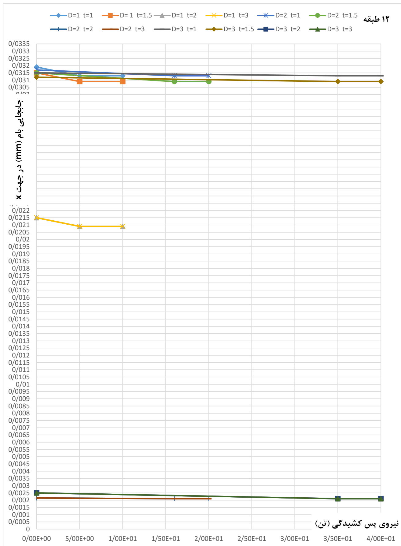
شکل (۴-۴۸) نمودار تاثیر افزایش نیروی پس کشیدگی کابل ها بر روی جابجایی بام در جهت X
