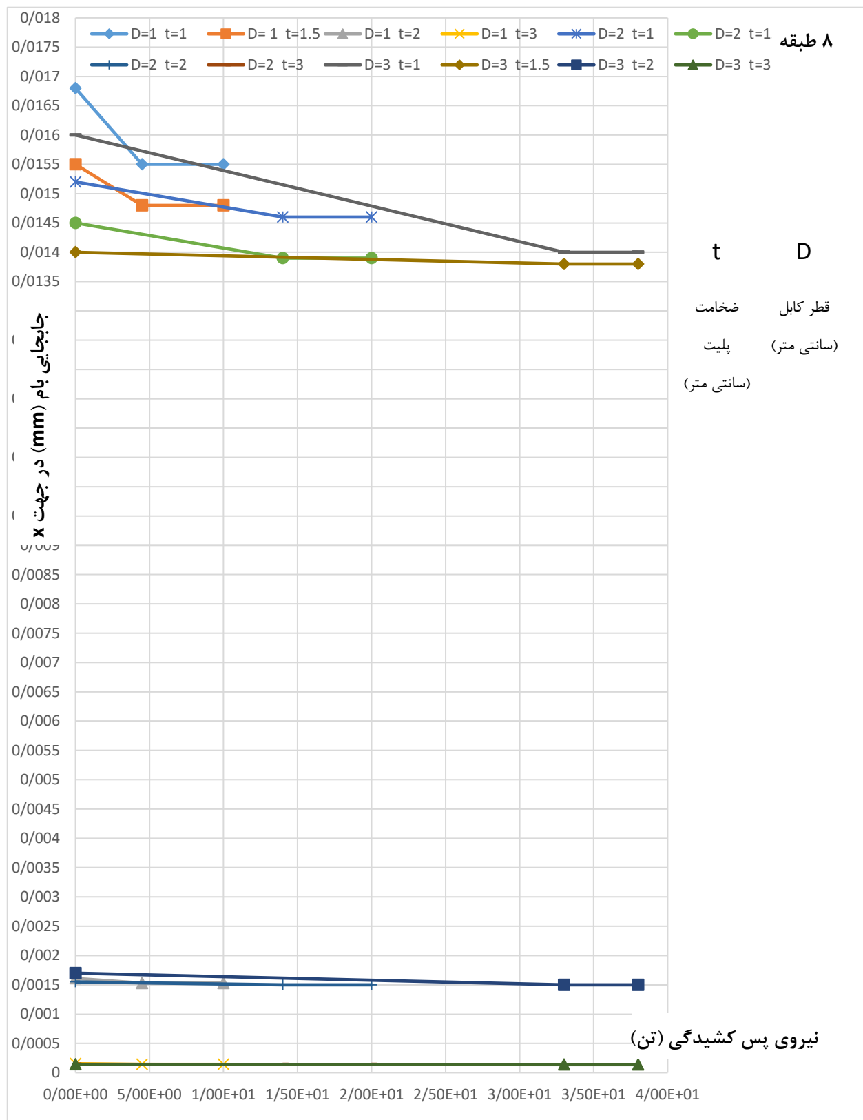
شکل (۴-۲۷) نمودار تاثیر افزایش نیروی پس کشیدگی کابل ها بر روی جابجایی بام ساختمان ۸ طبقه در جهت x
