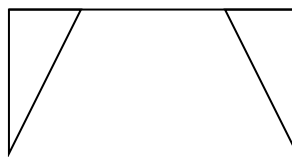
شکل (۱-۲) قاب مهاربندی شده واگرا
