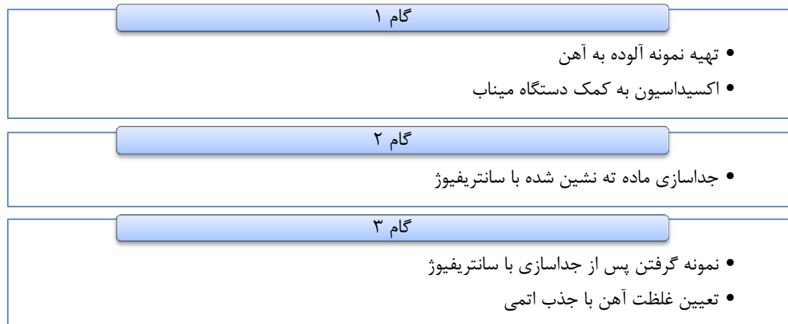
شکل ۲-۳ روند کلی آزمایش‌های حذف آهن
