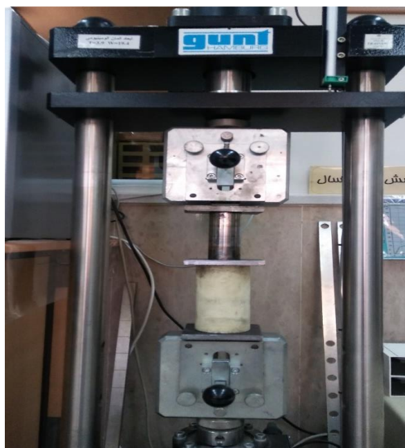
شکل ۱-۴: آزمایش مقاومت فشاری فوم پلی یورتان
