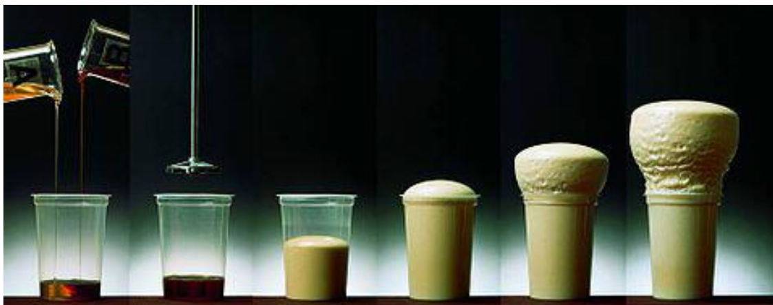
شکل ۲-۹: مراحل تشکیل فوم پلی یورتان [۳۷]
