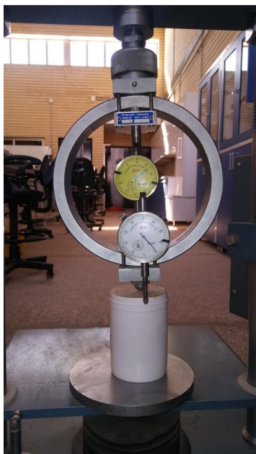
شکل ۴-۲۹: آزمایش نیروی بالا زدگی فوم با دستگاه تک محوری
