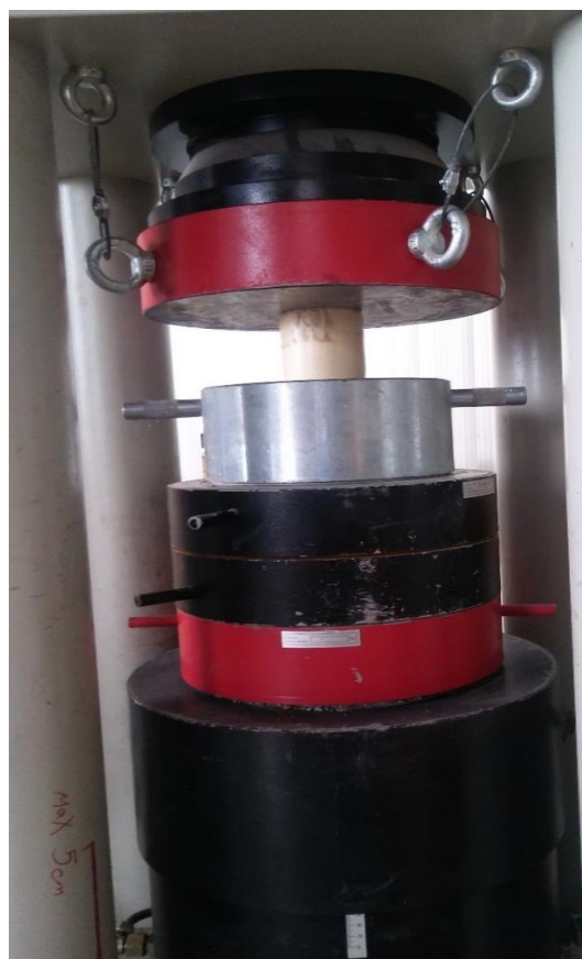
شکل ۴-۱۸: فوم با نسبت ۱۰۰ گرم ایزوسیانات به ۱۰۰ گرم پلی‌ال چوب با دانسیته ۵۶۰
