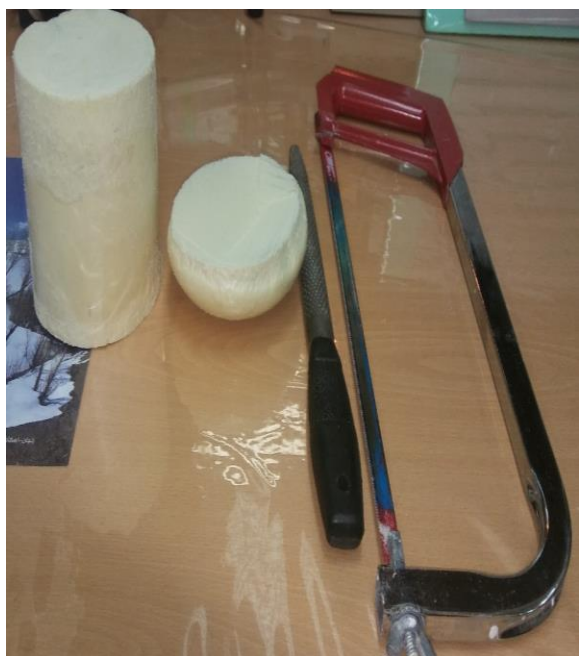
شکل ۲-۳: برش استوانه‌ای فوم با کمان اره و سمباده
