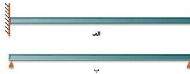
شکل ۵-۱. نمایش تیر: الف. اتصال یکسرگیردار، ب. اتصال دو سر مفصل
