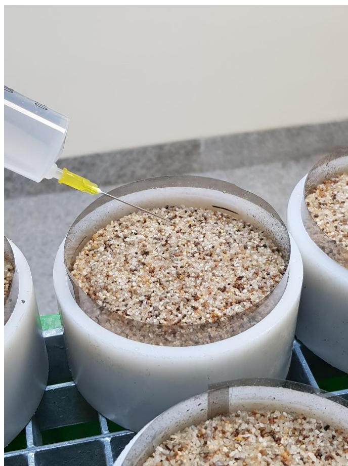
شکل (۳-۱۲) تزریق ثقلی به خاک با استفاده از سرنگ
