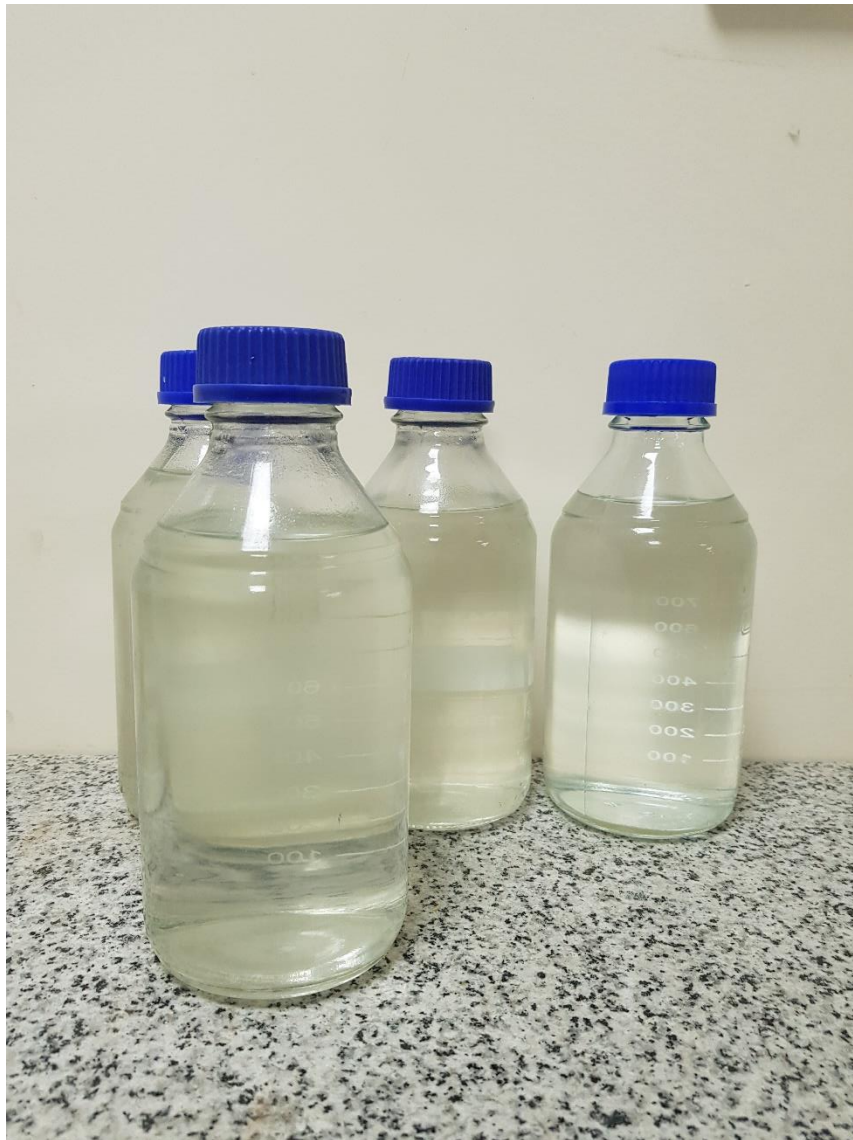
شکل (۳-۱۱) محلول سیمان‌تاسیون آماده شده برای تزریق
