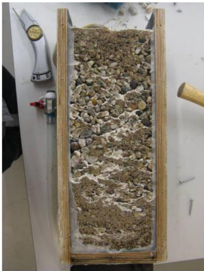
شکل (۲-۱۱) خاک بهسازی شده به روش بیولوژیکی توسط ون پاسن ۲۰۱۱ [۴]
