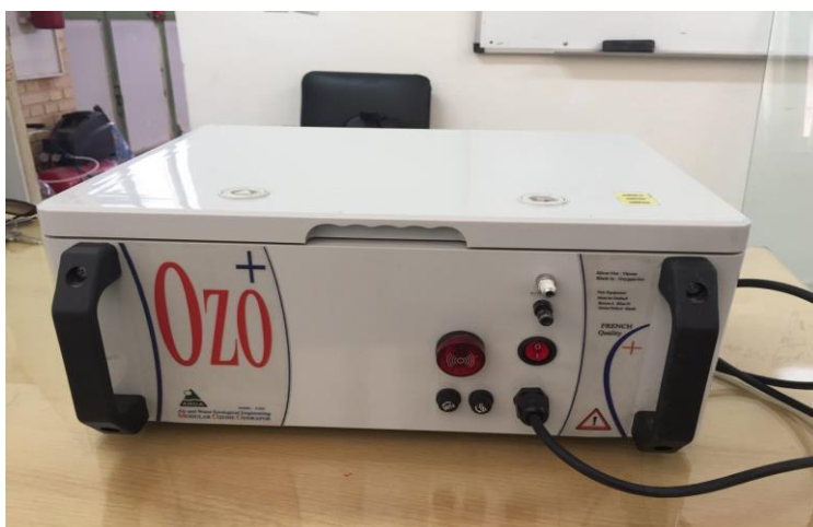
شکل ۳-۳ دستگاه ازن ساز سری ARDA ساخت کشور فرانسه
