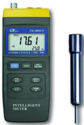
شکل ۱-۳ دستگاه pH سنج مدل YK-2001 CT
