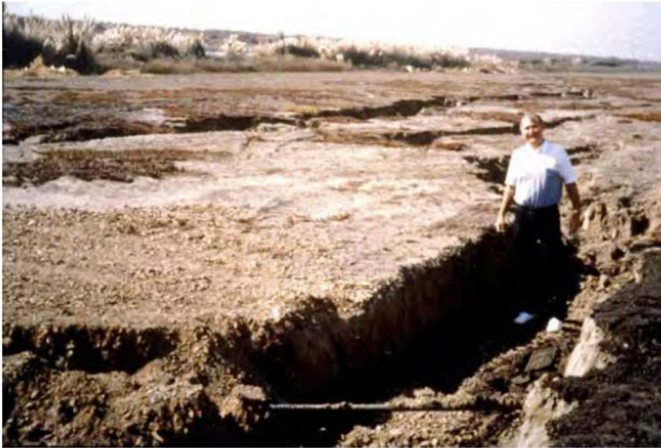
شکل ۲-۳ ایجاد فرورفتگی در زمین ناشی از پدیده گسترش جانبی (نشریه شماره ۵۲۵ معاونت برنامه‌ریزی و نظارت راهبردی رئیس‌جمهور)
