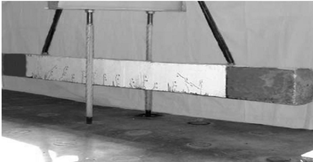
شکل (۴-۴) حالت آویزان نمونه برای انجام آزمون مودال (Baghiee et al., 2009)
