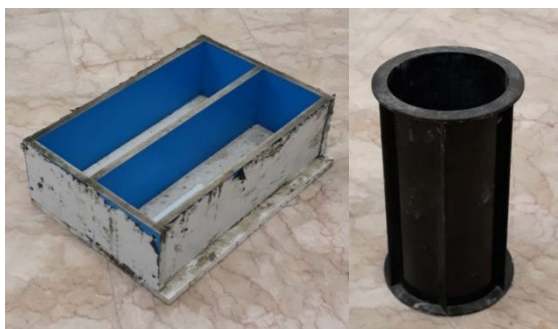
شکل ۴-۱۶ قالب‌های نمونه‌های استوانه‌ای و تیر خمشی
