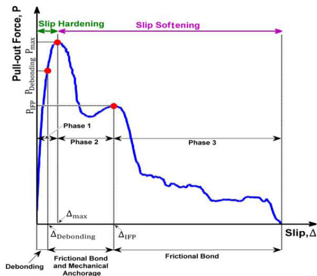
شکل ۴-۵ رفتار عمومی نیرو- لغزش الیاف قلابدار در روند بیرون کشیدگی از ماتریس بتن الیافی [۵۱ و ۵۲]
