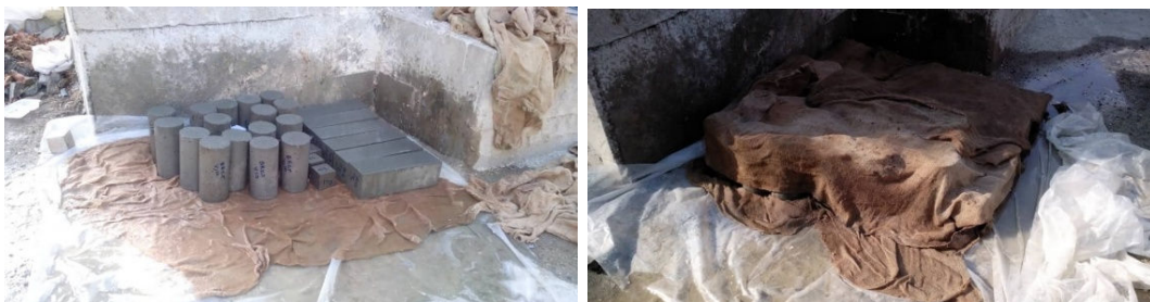
شکل ۴-۱۸ شرایط نگهداری نمونه‌های آزمایشگاهی مقاومت فشاری و کششی غیر مستقیم و خمشی
