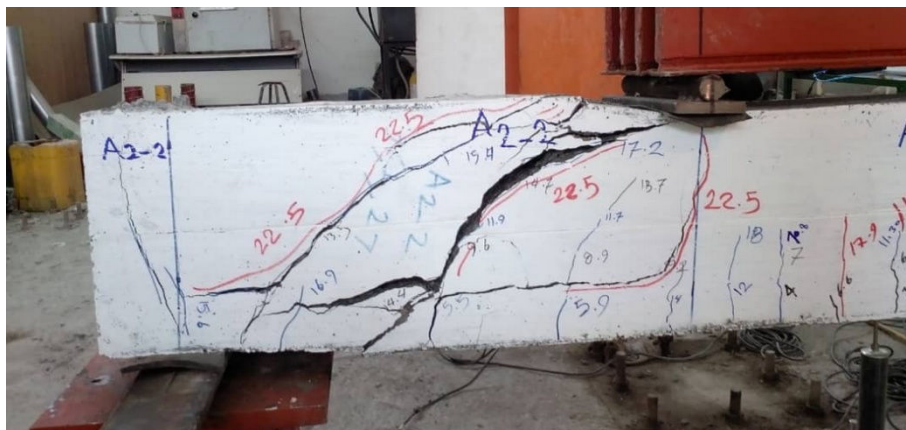
شکل ۵-۹ شکل خرابی نمونه A ۲-۲
