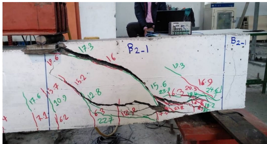
شکل ۱۸-۵ شکل خرابی برشی نمونه B_{2-1}
