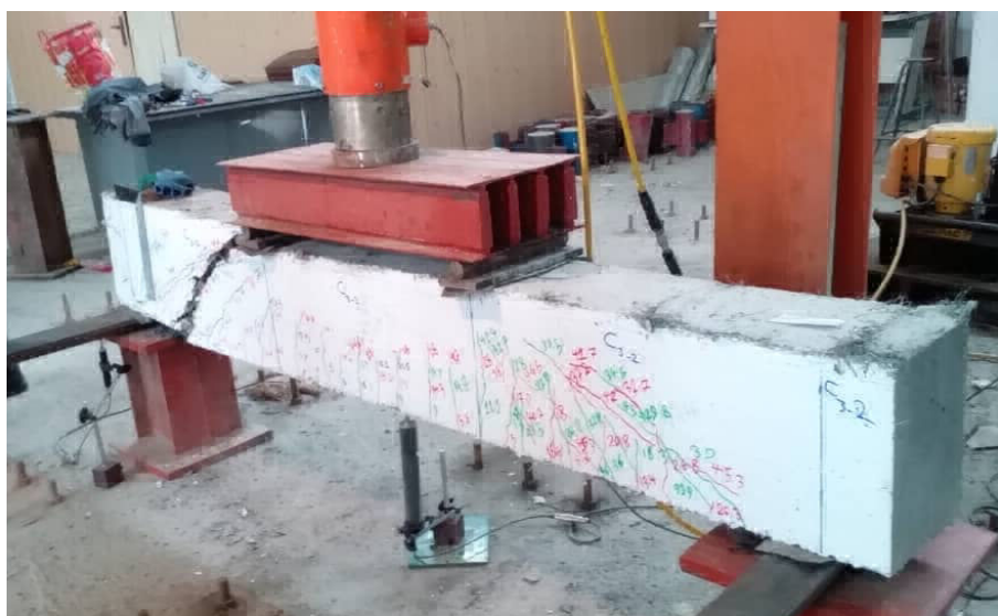
شکل ۶- شکل خرابی برشی نمونه C۳-۲
