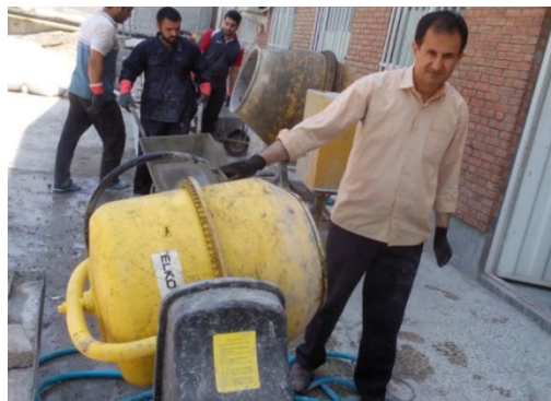
شکل ۴-۳ بتونیر برای ساخت طرح‌های آزمایشی
