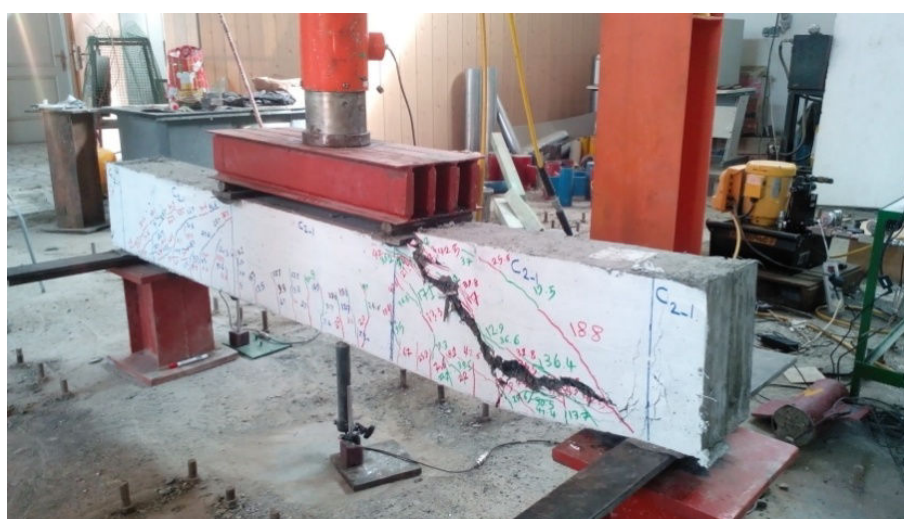
شکل ۲۸-۵ شکل خرابی برشی نمونه C 2-1
