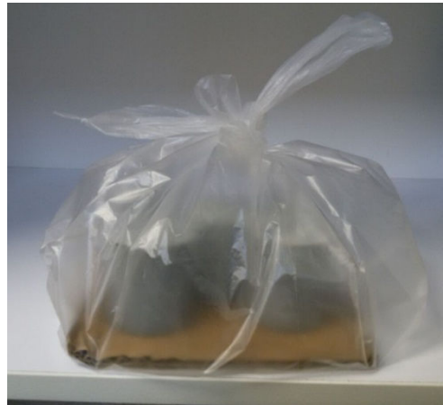
شکل ۴-۱۰ محفظه پلاستیکی سرپوشیده جهت نگهداری نمونه‌ها
