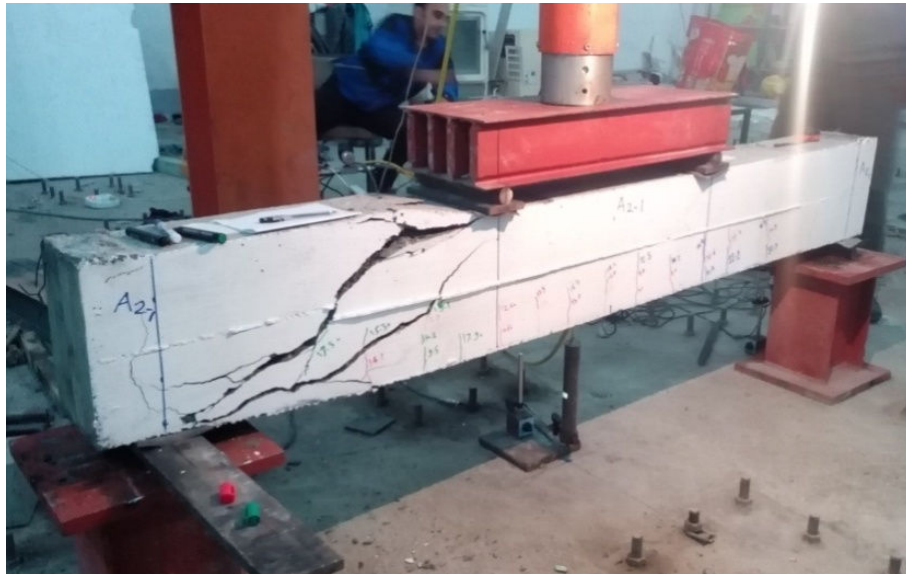
شکل ۵-۸ شکل خرابی نمونه A ۲-۱
