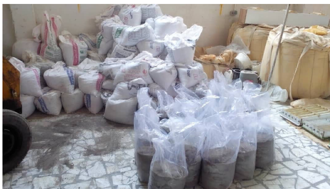
شکل ۴-۴ بسته بندی مصالح سنگی برای حفظ درصد رطوبت
