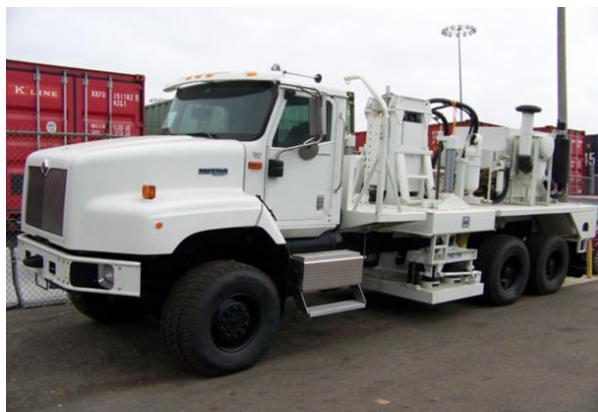
شکل ۲-۸. کامیون مخصوص ویبراتور لرزه‌ای [۲۶]
