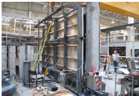
شکل ۴-۵. نحوه بارگذاری نمونه قاب میان‌پر مصالح بنایی آزمایشگاهی در جهت خارج از صفحه [۱۳]
