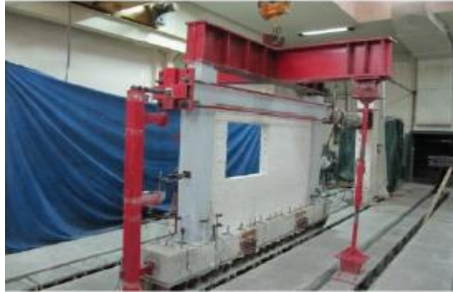
شکل ۳-۳. برپایی دستگاه بارگذاری نمونه‌های آزمایشگاهی [۹۵]
