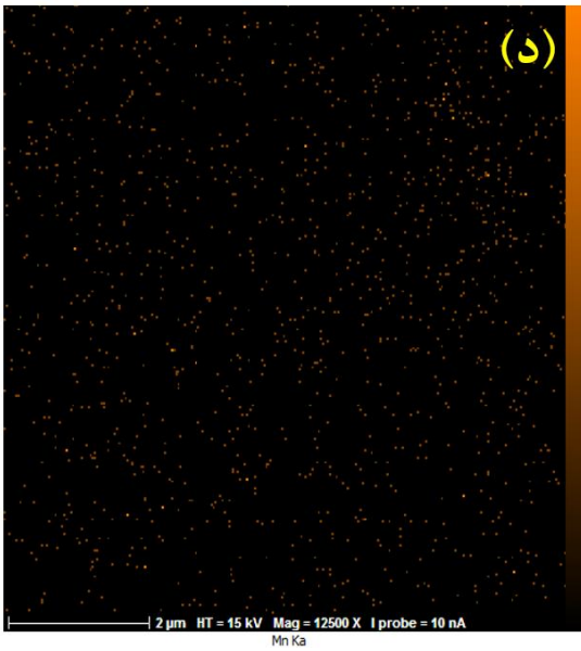
شکل ۴-۹- آنالیز صفحه‌های EDX و نحوه توزیع عناصر بر روی سطح جاذب سپیولیت اصلاح شده، الف) کربن، ب) اکسیژن، ج) سیلیس و د) منگنز
