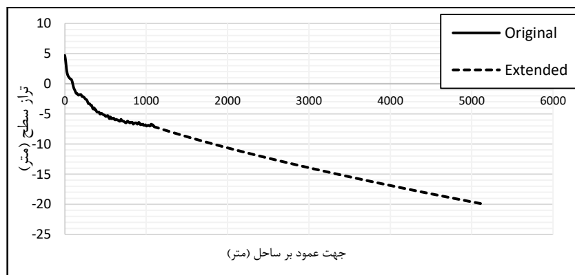
شکل ۳-۴ یک نمونه نیمرخ امتداد یافته با استفاده از نیمرخ تعادلی Dean
