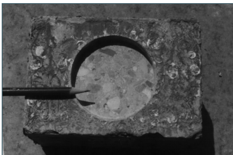
تصویر ۸- نمونه منشوری پس از پروفیل گیری
