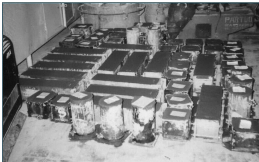
تصویر ۱- قالب‌گیری آزمون‌های مکعبی، استوانه‌ای و منشوری
