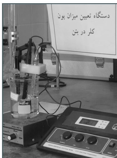
تصویر ۱۰- اندازه گیری مقدار یون کالر محلول ها به روش تیتراسیون پتانسیومتری
