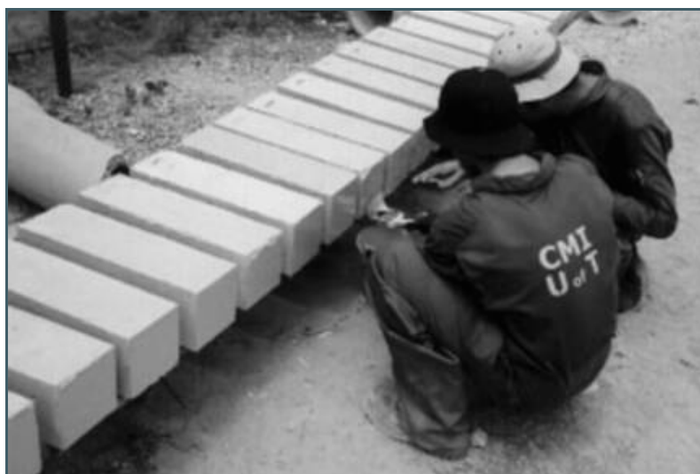
تصویر ۱- قالب‌گیری آزمون‌های مکعبی، استوانه‌ای و منشوری
