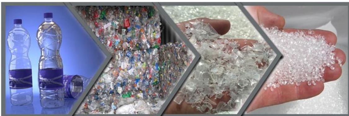
شکل ۳-۱۱ فرایند بازیافت و تبدیل پت ضایعاتی به گرانول‌های پلیمری قابل ذوب مجدد
