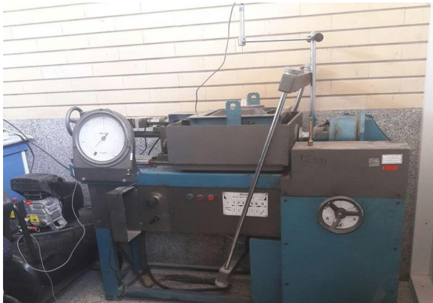
شکل ۳-۱۸ دستگاه برش مستقیم بزرگ‌مقیاس آزمایشگاه خاک دانشگاه صنعتی شاهرود
