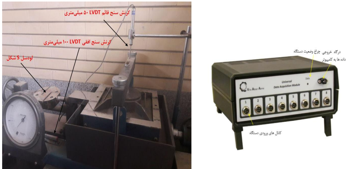
شکل ۳-۱۹ دیتالاگر و سنسورهای به‌کاررفته در این پژوهش
