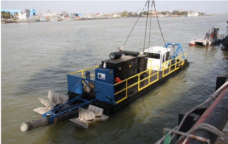
شکل ۷-۳ نمونه کشتی لایروب تحت اختیار سازمان بنادر و دریانوردی بندر انزلی
