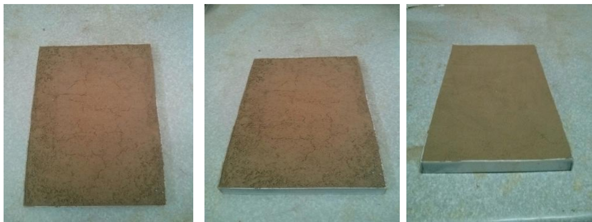
شکل ۴-۲۵: نمایی از نمونه خاک مالچ پاشی شده با مالچ منتخب (۰,۷ درصد، پاشش ۲۵ میلی لیتر): سطح خاک صاف شده قبل از مالچ پاشی (الف)، سطح خاک خشک شده در آون پس از مالچ پاشی (ب)، سطح خاک پس از انجام آزمایش فرسایش بادی و قرار گیری نمونه طی ۵ دقیقه در مقابل سرعت باد ۱۵ متر بر ثانیه (پ).
