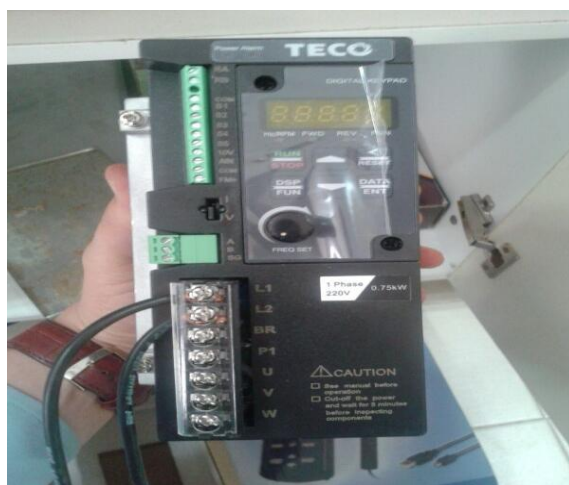
شکل ۳-۹: دستگاه اینورتر سه فاز به تک فاز مورد استفاده در این تحقیق
